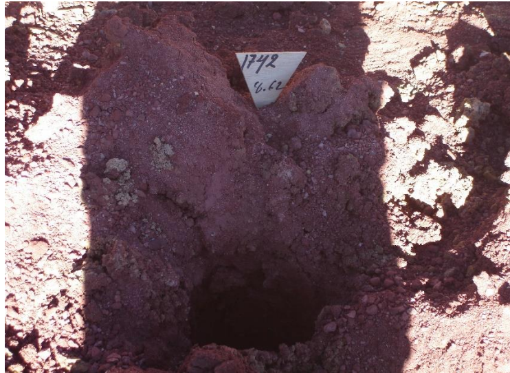
Fotografía 5, 3: Identificación del número y profundidad del taladro
