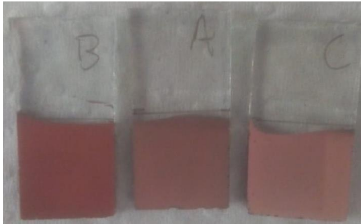
Figura 23. Película de FTO/Cu depositada a -1.5 por 5 segundos seguido de -0.6 por 200 segundos (B=Cu 50mM, A=Acetato 48mM, C=PVP 1%)
