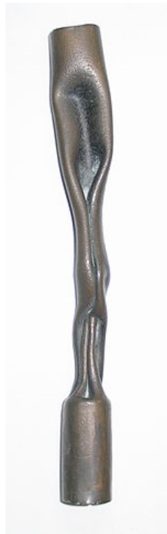
Figura 2.3: Conductor eléctrico experimenta efectos de compresión debido a la interacción con campo magnético.
