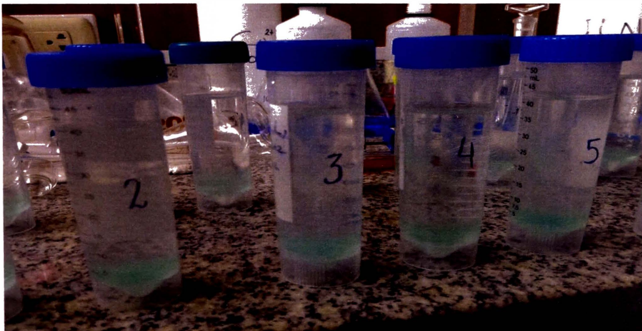
Figura 10. Ensayos de sorción de iones cobre a pH 6 usando Xan-Alg 2 , Xan-Alg 3 , Xan-Alg 4 y Xan-Alg 5 .
