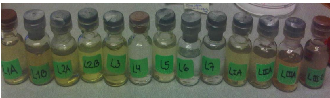
Figura 16: Fotografía de las muestras de la serie L, preparadas por el sistema óptico de desviación del láser. Fotografía tomada minutos antes de la caracterización por Microscopía Electrónica de Transmisión. Los parámetros utilizados para la preparación se resumen en la tabla N° 5.
