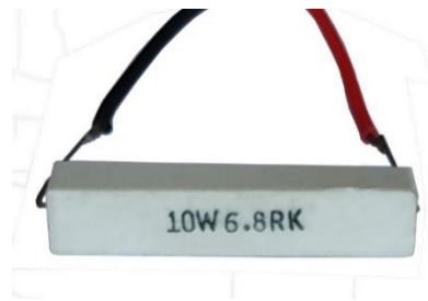
Figura 3.12: Resistencia de potencia 10 W y 6,8 \Omega .
