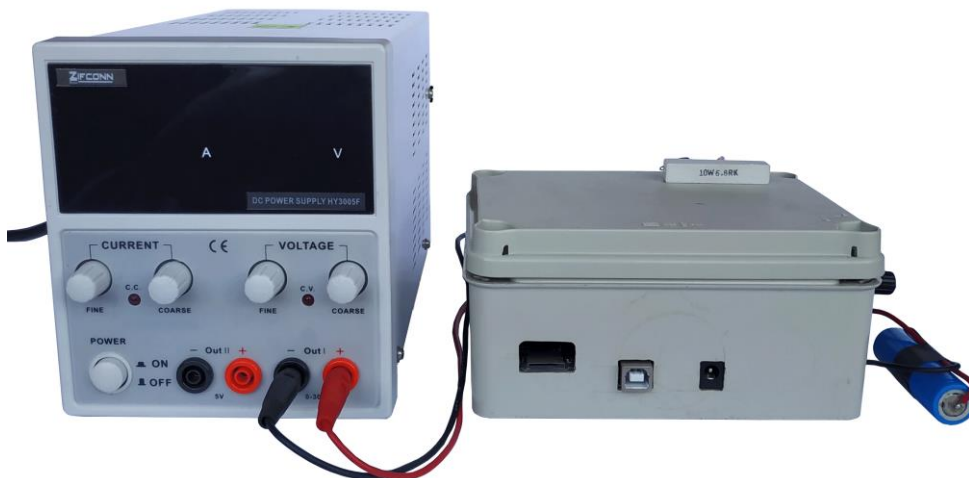
Figura 3.17: Ciclador con la Batería, la fuente y la resistencia de carga conectadas.
