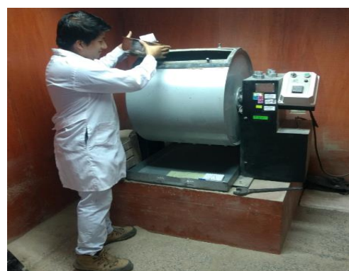
Máquina de Abrasión de Los Ángeles, para el agregado grueso.
