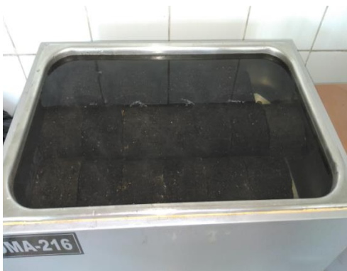
Mezcla patrón, baño maría a 60°C, durante 30 min.
