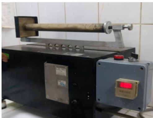
Equivalente de Arena, agitador mecánico.
