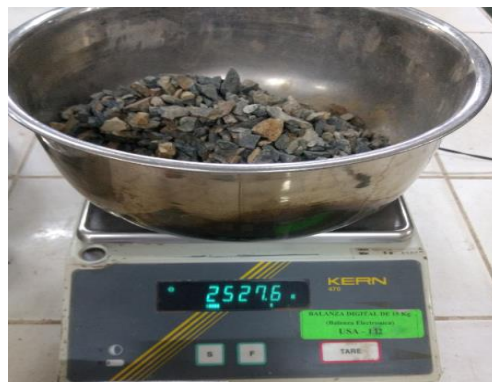
Gravedad específica y Absorción. Peso seco del agregado grueso.
