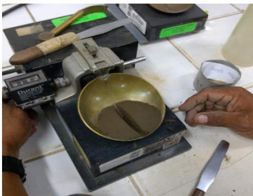
Copa de Casagrande, determinación del límite líquido.
