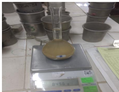
Gravedad específica y absorción del agregado fino.
