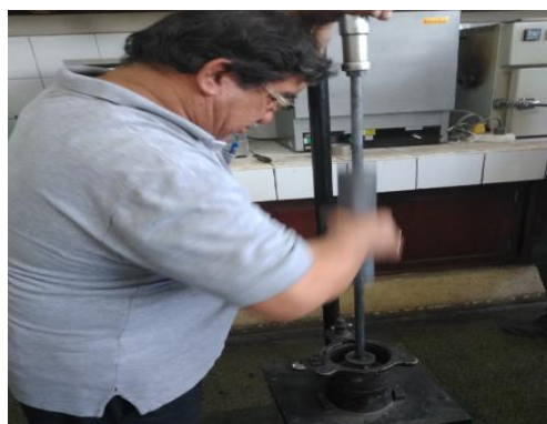
Mezcla patrón, compactación de briquetas.
