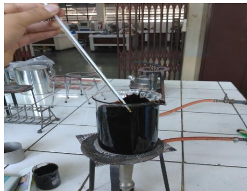
Control de la temperatura del cimento asfáltico.
