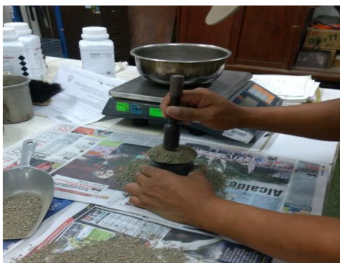
Condición saturada superficialmente seca del agregado fino.
