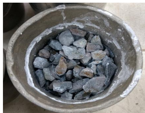
Muestra de Agregado grueso después de haber sido sometido al horno.
