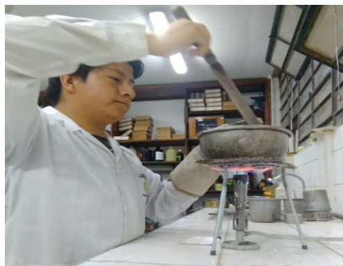
Secado de la muestra de agregado fino saturado
