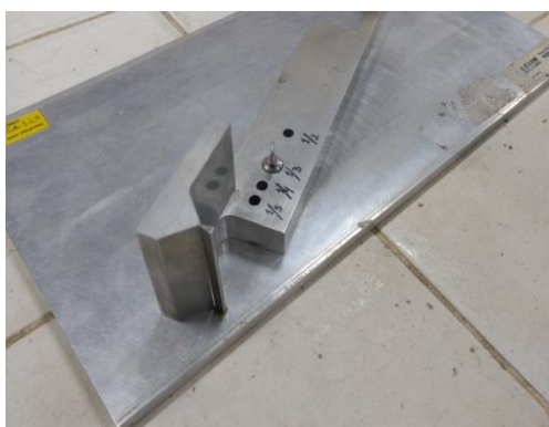
Calibrador proporcional, ensayo de partículas chatas y alargadas.
