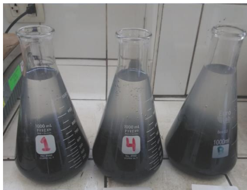
Peso específico teórico máximo, agua más muestra asfáltica.
