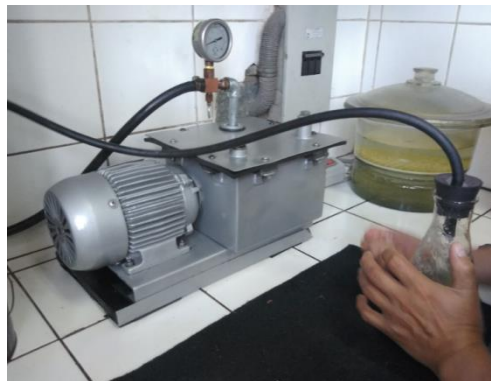
Peso específico teórico máximo, extracción de aire atrapado.
