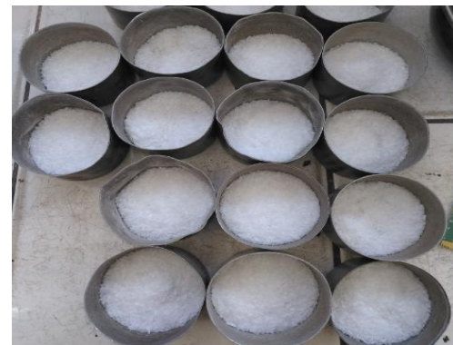
Porcentajes de PEAD reciclado en función al peso de los agregados.
