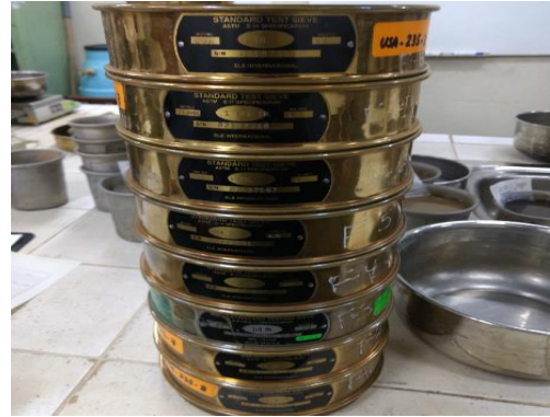
Tamices para granulometría, de la malla 2" a la malla N°4.
