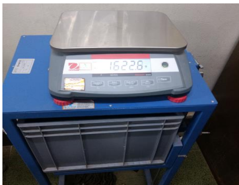
Peso en el agua del agregado saturado superficialmente seco.
