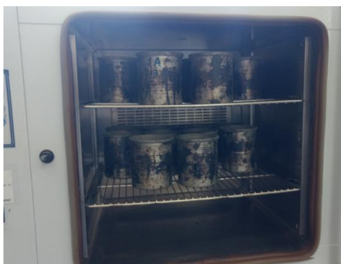
Secado al horno a 110°C del agregado grueso inmerso en la solución.
