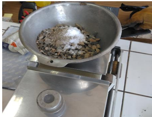
Mezcla con PEAD, incorporación de PEAD reciclado en los agregados.
