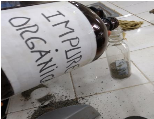
Determinación cualitativa de impurezas orgánicas, agregado fino.
