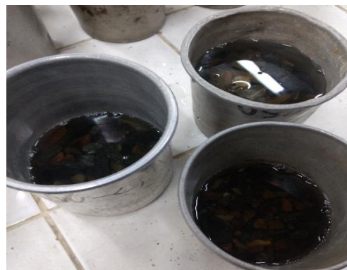
Inmersión del agregado grueso en la solución de sulfato de Magnesio
