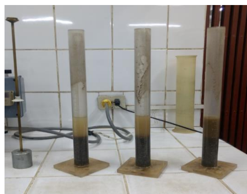
Ensayo para la determinación del equivalente de arena.
