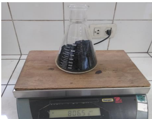
Peso específico teórico máximo, peso de la muestra asfáltica suelta.
