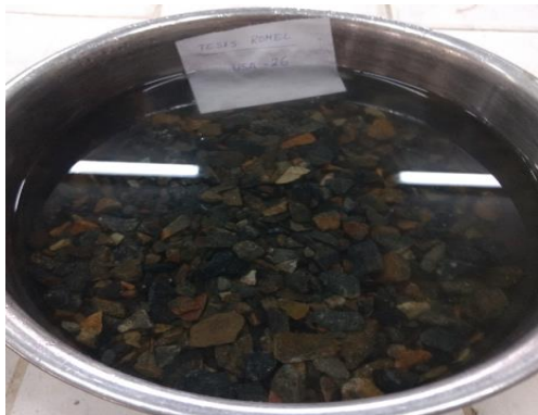
Gravedad específica y Absorción. Saturación del agregado grueso.
