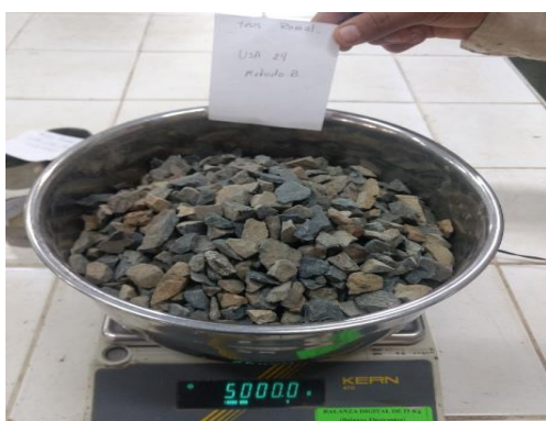
Muestra de agregado grueso para el Ensayo de Abrasión, método B.
