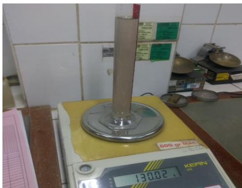
Determinación de la densidad de la solución con sulfato de Magnesio.
