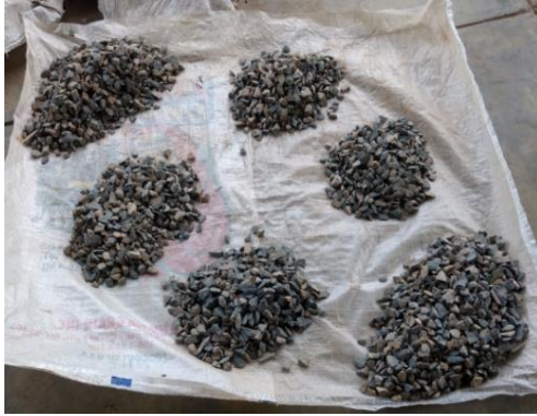
Cuarteo, agregado grueso retenido en la malla \frac{3}{4} ".
