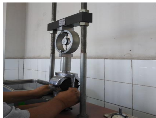
Mezcla patrón, determinación de la estabilidad y el flujo Marshall.
