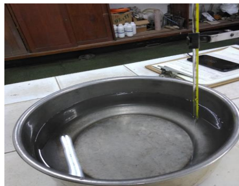
Mezcla patrón, control de temperatura del agua de 25°C.
