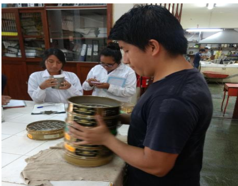
Ensayo de granulometría de los agregados.
