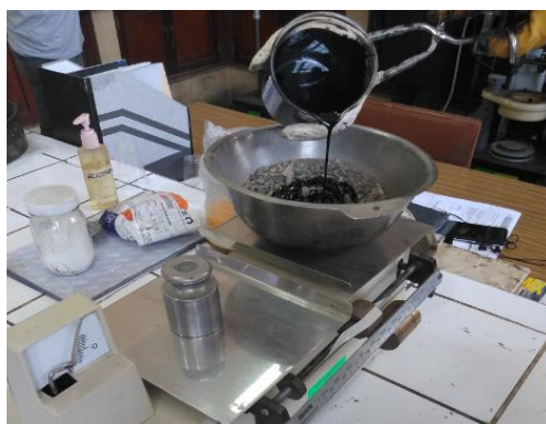
Mezcla patrón, dosificación de agregados y cemento asfáltico.
