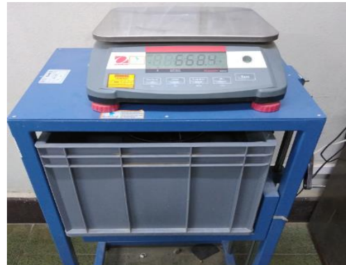
Mezcla patrón, peso de la briqueta en agua.
