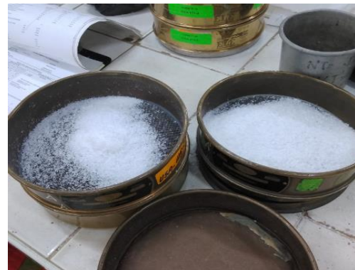
Determinación de la granulometría del PEAD reciclado.
