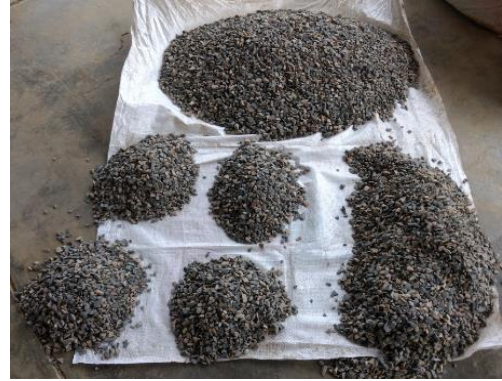
Cuarteo, agregado grueso retenido en la malla N°4.
