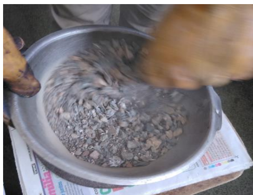
Mezcla con PEAD, mezclado de agregados y PEAD reciclado
