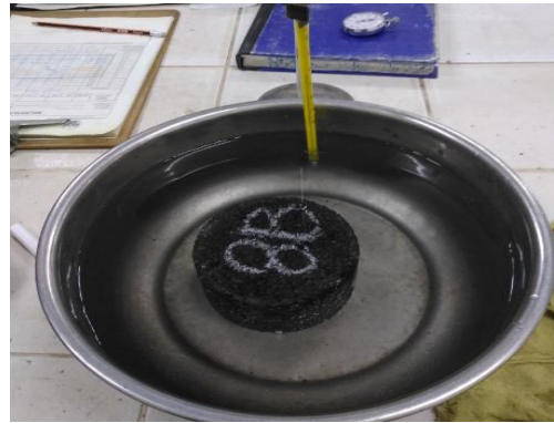
Mezcla patrón, inmersión de la briqueta en agua.
