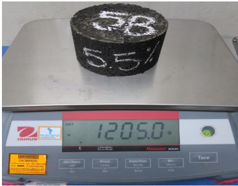
Mezcla patrón, peso de la briqueta en el aire.
