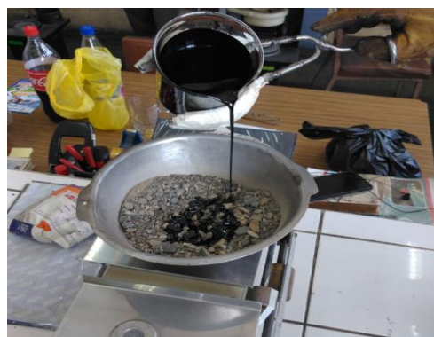
Mezcla con PEAD, adición de cemento asfáltico.
