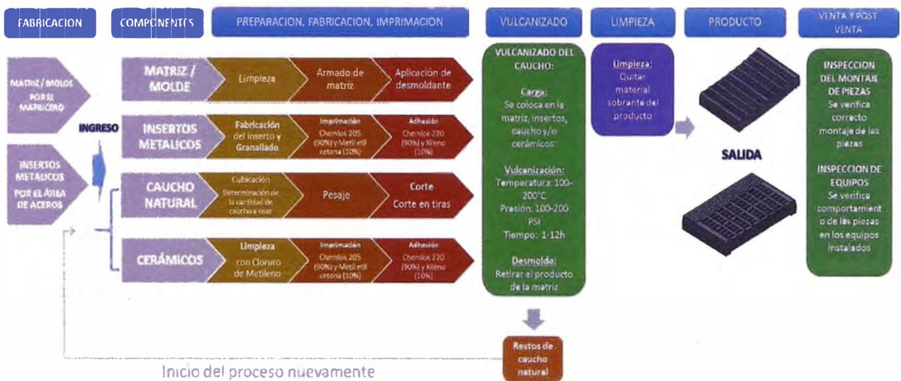
Figura 4.2.2 Proceso de fabricación del caucho
