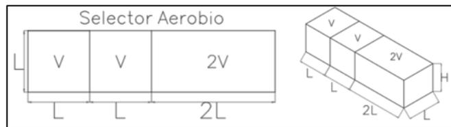
**Figura 3.7.** Disposición de los volúmenes de los compartimentos del selector
