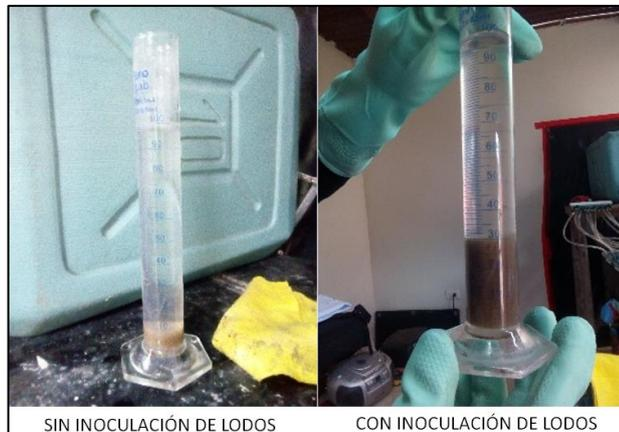
**Fotografía 4.1** . Formación de lodo antes y después de la inoculación de lodos
