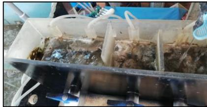
**Fotografía 5.1.** Saturación del selector debido a la formación y acumulación de lodos de gran tamaño
