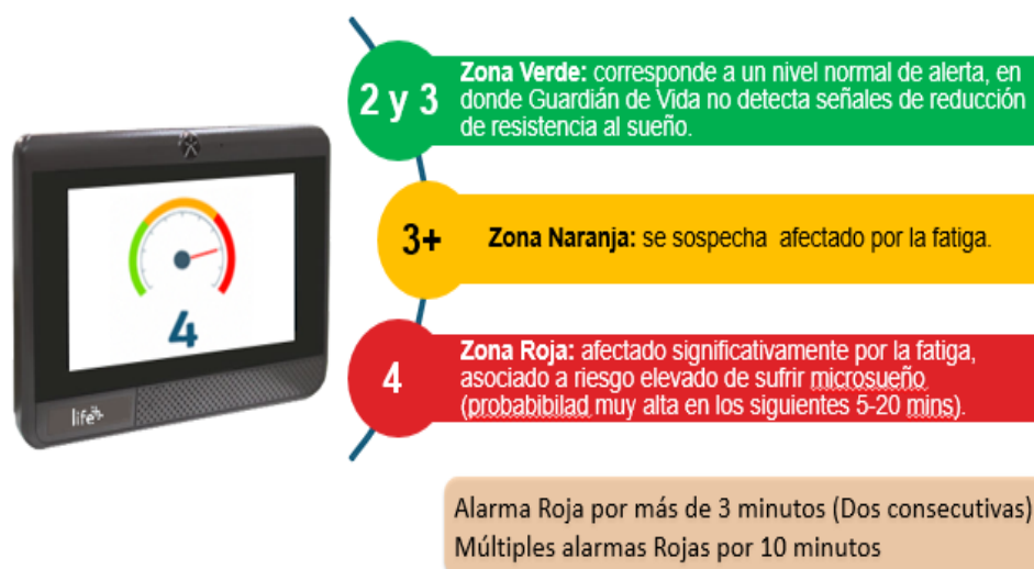
Figura 2.3. Niveles que controla el smart cap
