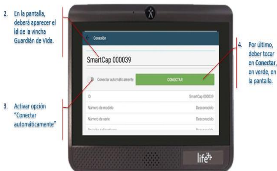
Figura 2.2. Forma de conectarse en el display
