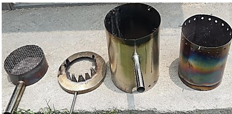
Figura 58. Vista de los componentes de la cocina con sistema de microgasificación.
