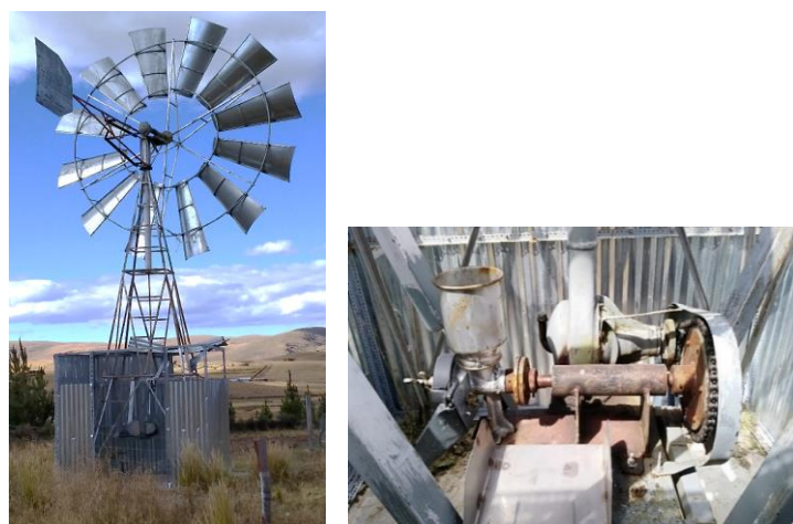
Figura 36. Vista del molino de granos expuesta a la intemperie.
