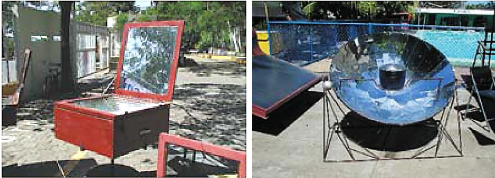
Figura 22. (Izq.) Vista de cocina de acumulación tipo caja. (Der.) Cocina parabólica de concentración (BUN-CA, 2002b).
