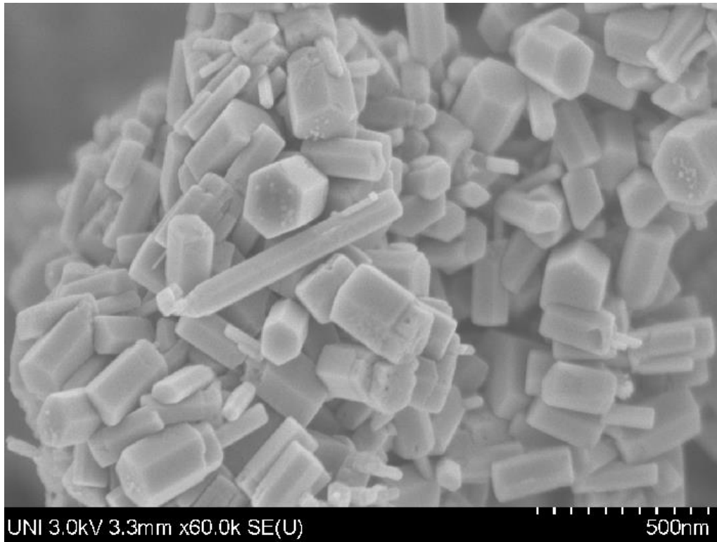
Figura 5.2.a SEM de ZnO (Estructura hexagonal Wurzita).
