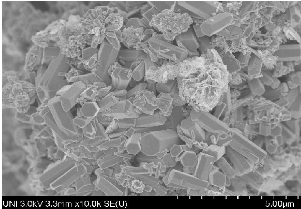
Figura 5.11.b SEM de ZnO con partículas de \text{Al}_2\text{O}_3 (20 mM \text{Al}(\text{NO}_3)_3 ).
