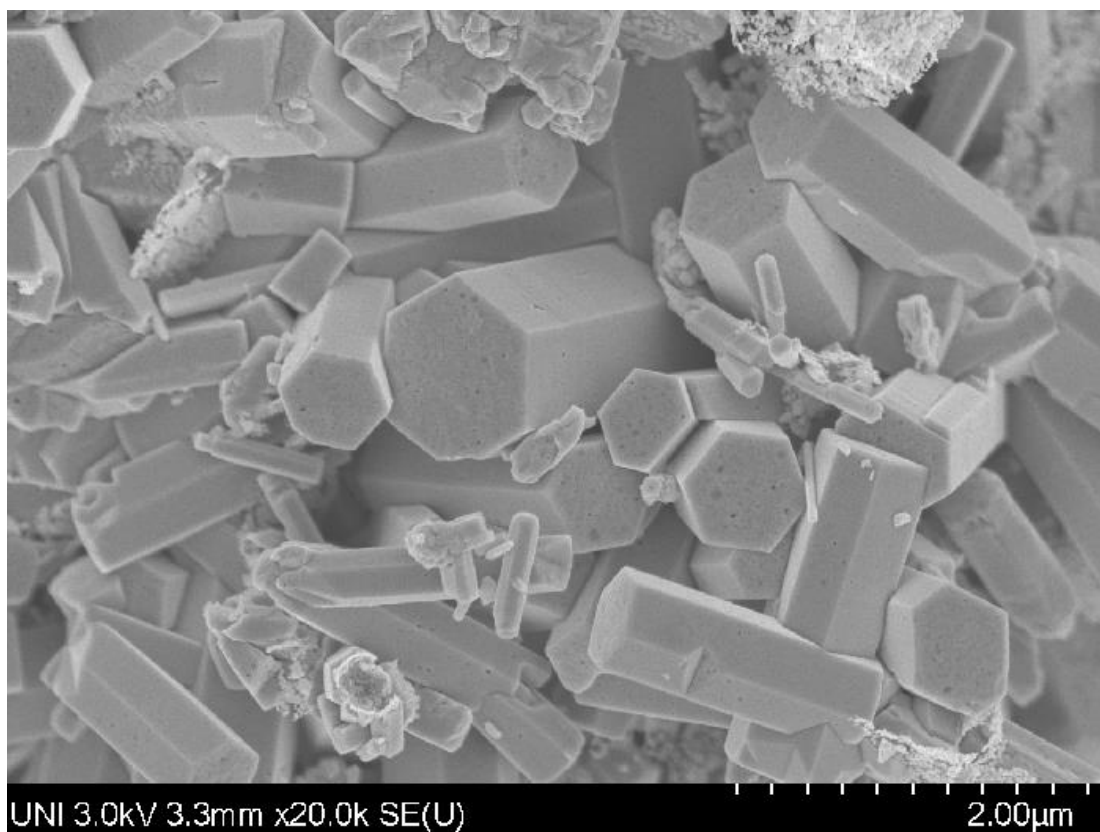
Figura 5.2.d SEM de ZnO con nanopartículas de Al 2 O 3 (3%).
