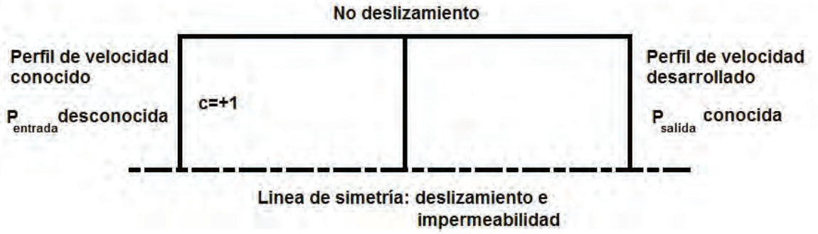
Figura 2.4: Condiciones de contorno para la malla generada.
