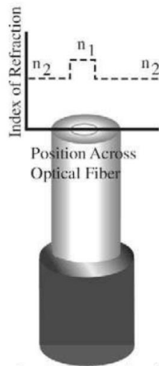
Figura 3. Perfil radial del índice de refracción al interior de la fibra óptica [1]
