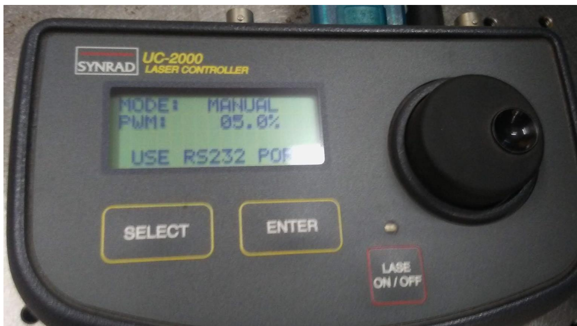
Figura 51. Prueba de funcionamiento de controlador de láser
