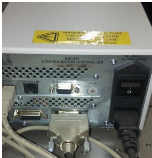
Figura 41. Controlador de motor a pasos de movimiento horizontal
