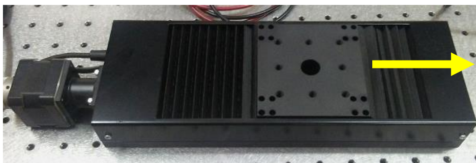
Figura 52. Pruebas de funcionamiento de base móvil horizontal
