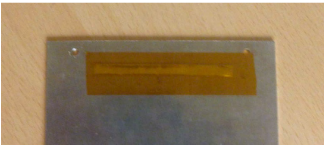
Figura 7.2: Instalación de una lámina de histéresis en la cara del Chasqui I
