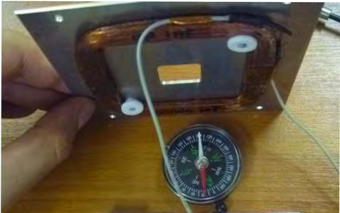
Figura 7.6: Verificación de la dirección del momento magnético generado por una bobina
