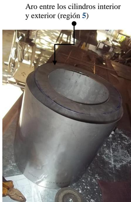
**Figura 4.21.** Aro entre los cilindros interior y exterior.
