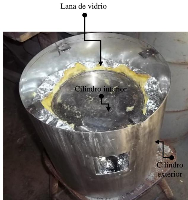
**Figura 4.22.** Espacio entre los cilindros interior y exterior, cubierto con lana de vidrio.
