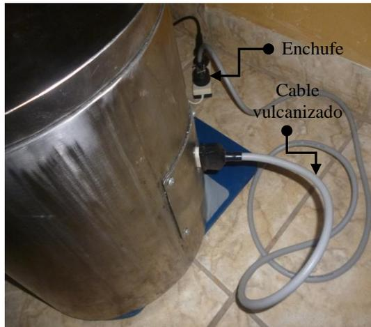
**Figura 4.32.** Conexión de la resistencia eléctrica.
