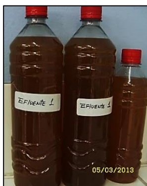
Figura 3.14. Efluente proveniente del proceso de deshidratación del lodo de perforación
