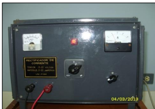
Figura 4.11. Fuente de poder UNI-FIQT. Laboratorio N° 11. Posición 1 (Encendido).
