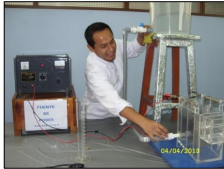
Figura 4.23. Apertura de la válvula de salida del tanque de almacenamiento del efluente. Sistema de electrocoagulación de flujo continuo. UNI-FIQT, Laboratorio N° 11.
