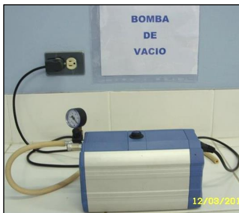
Figura 4.4. Bomba de vacío GAST, modelo DOA-P504-BN. Propiedad de Baker Hughes Operaciones Perú. UNI-FIQT. Laboratorio N° 11.
