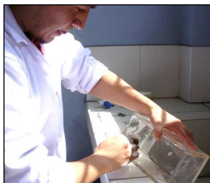
Figura 4.16. Lavado del reactor de electrocoagulación para procesos por lotes. UNI-FIQT, Laboratorio N° 11.
