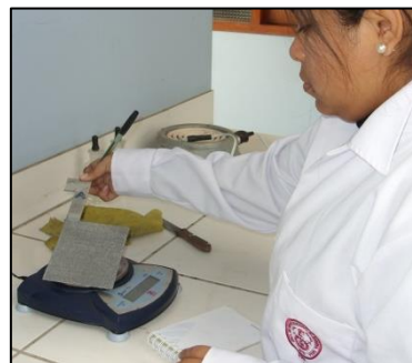
Figura 4.30. Pesado de los electrodos de Aluminio al finalizar el proceso de electrocoagulación en flujo continuo. UNI-FIQT, Laboratorio N° 11.
