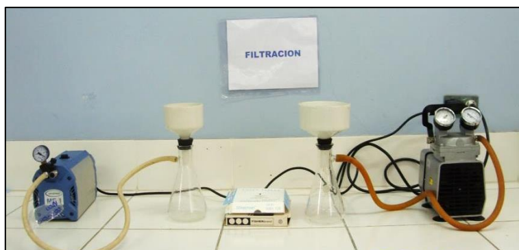
Figura 4.5. Sistema de filtración. UNI-FIQT, Laboratorio N° 11.
