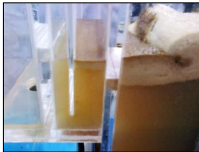
Figura 4.41. Separación de flóculos formados en el separador de sólidos del reactor de electrocoagulación del sistema de flujo continuo durante el tratamiento. UNI-FIQT, Laboratorio N° 11.
