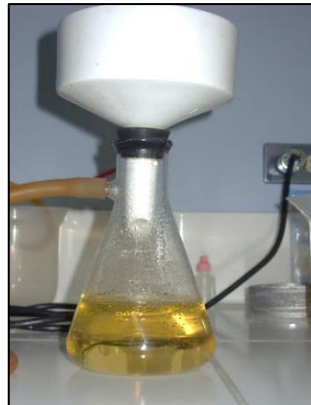
Figura 4.32. Filtrado del efluente tratado después del proceso de electrocoagulación. Sistema de flujo continuo. Vista lateral: Embudo y Kitasato. UNI-FIQT, Laboratorio N° 11.
