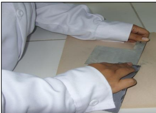
Figura 4.7. Lijado de electrodos de Aluminio para el proceso experimental por lotes. Laboratorio N° 11. UNI-FIQT
