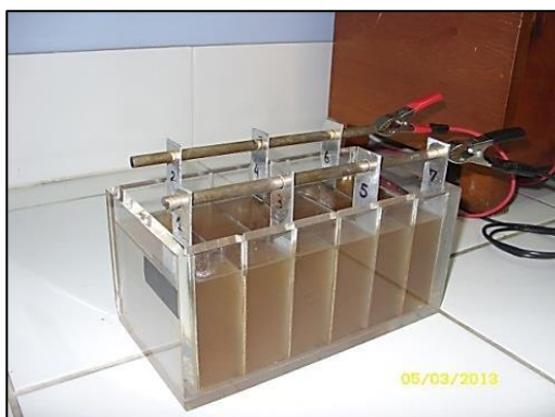
Figura 4.10. Reactor para el proceso de electrocoagulación por lotes lleno con efluente listo para tratamiento. UNI-FIQT. Laboratorio N° 11.
