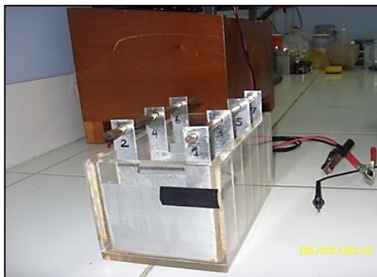
Figura 4.9. Reactor para el proceso de electrocoagulación por lotes y conexiones hacia la fuente de poder. UNI-FIQT. Laboratorio N° 11.
