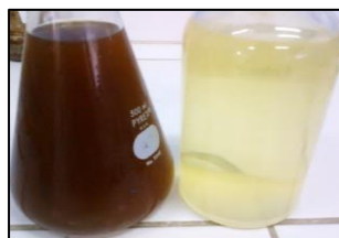
Figura 4.36. Diferenciación de color del efluente y efluente tratado. Derecha: efluente después del proceso electroquímico. Izquierda: Efluente procedente del lodo de perforación sin tratamiento. UNI-FIQT, Laboratorio N° 11.
