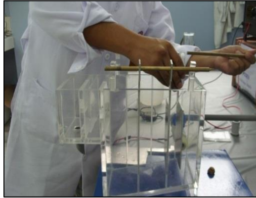
Figura 4.21. Montaje de los cátodos de Aluminio con la varilla de cobre en el reactor de electrocoagulación para el arreglo en flujo continuo. UNI-FIQT, Laboratorio N° 11.
