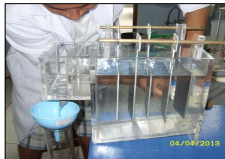
Figura 4.24. Apertura de la válvula de ingreso al reactor de electroquímico para el llenado del reactor. Sistema de electrocoagulación de flujo continuo. UNI-FIQT, Laboratorio N° 11.
