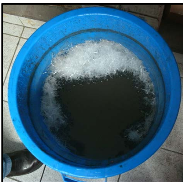
Figura 50: Efluente obtenido luego de EC con electrodos de Al. UNI – FIQT Laboratorio de fisicoquímica N° 11
