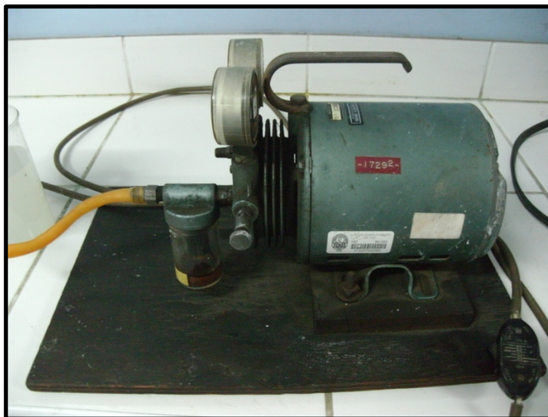
Figura 48: Bomba centrífuga utilizada para filtración al vacío. UNI – FIQT Laboratorio de fisicoquímica N° 11
