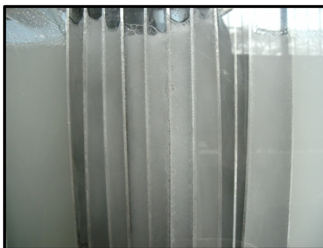
Figura 53: Efluente tratado con electrodos de Aluminio. UNI – FIQT Laboratorio de fisicoquímica N° 11
