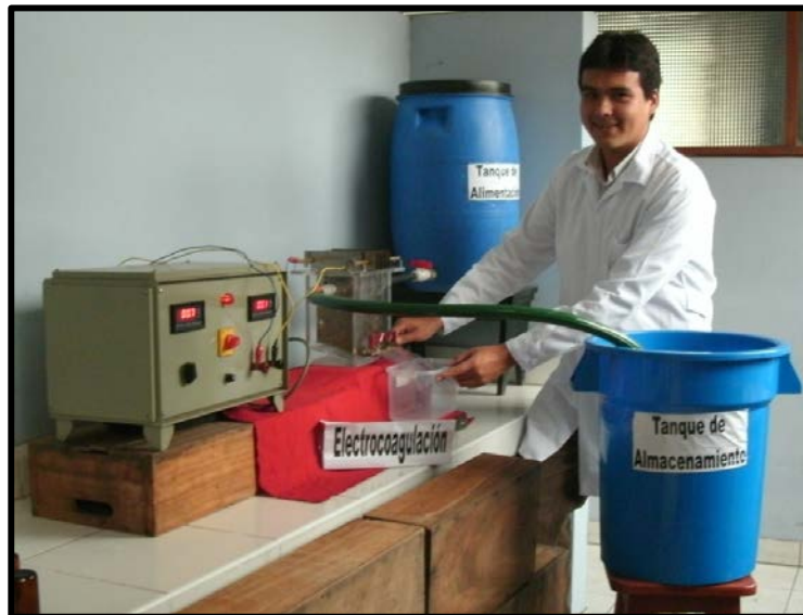
Figura 58: Montaje del sistema flujo continuo. UNI – FIQT Laboratorio de fisicoquímica N° 11
