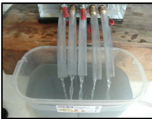
Figura 54: Desfogue de lodos del Reactor flujo continuo. UNI – FIQT Laboratorio de fisicoquímica N° 11
