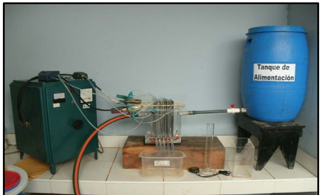
Figura 59: Sistema de EC con flujo continuo. UNI – FIQT Laboratorio de fisicoquímica N° 11
