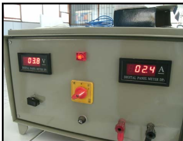
Figura 26: Rectificador de corriente regulación fina. Voltaje 0 – 10 v. Amperaje 0 – 15 A
