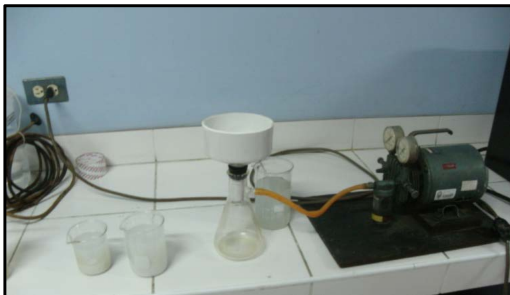
Figura 47: Sistema de filtración al vacío. UNI – FIQT Laboratorio de fisicoquímica N° 11
