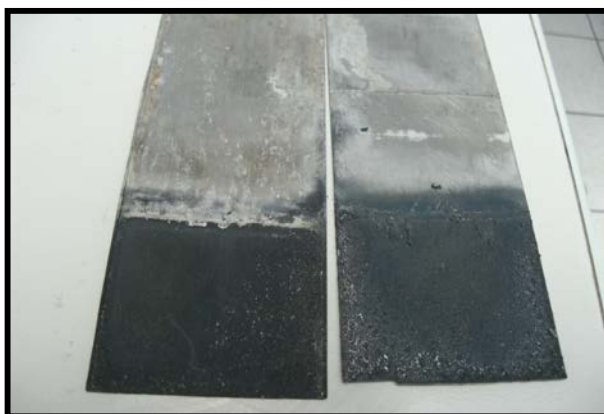
Figura 33: Electroodos de Aluminio con presencia de capa pasivante. UNI – FIQT laboratorio de fisicoquímica N° 11
