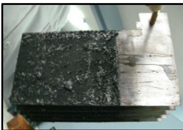
Figura 41: Capa pasivante en electrodos de Fe. UNI – FIQT Laboratorio de fisicoquímica N° 11
