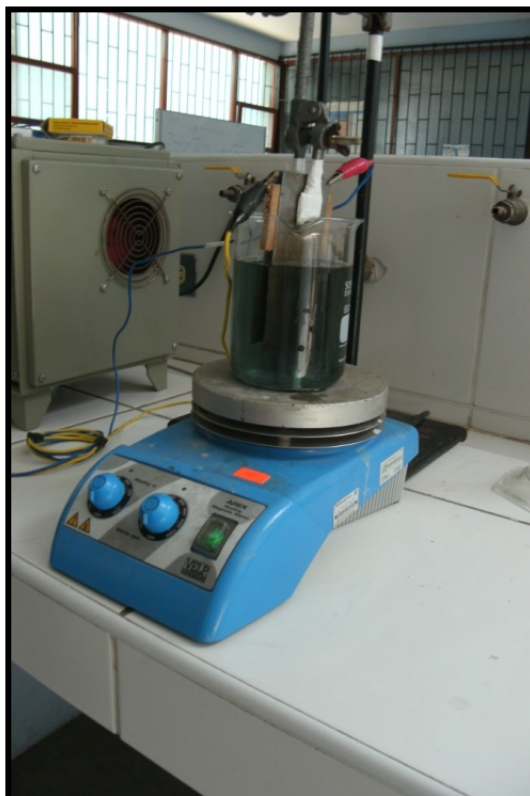
Figura 24: Sistema del Reactor por lotes. UNI – FIQT Laboratorio de fisicoquímica N° 11
