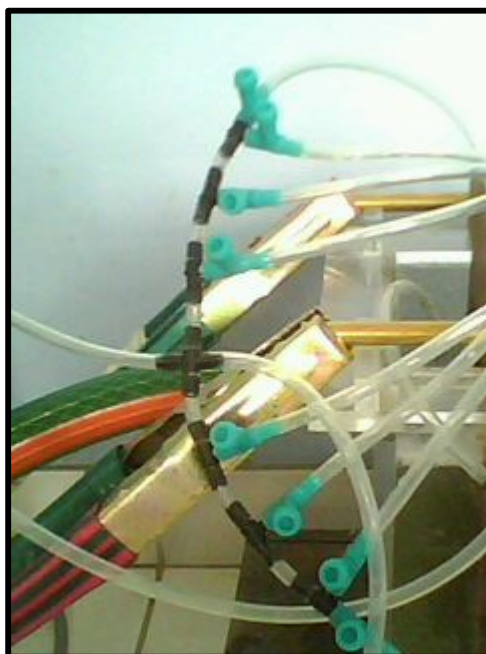
Figura 46: Contactos eléctricos usados para conectar el reactor al rectificador. UNI – FIQT Laboratorio de fisicoquímica N° 11
