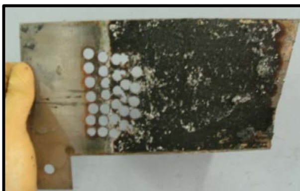
Figura 42: Electrodo de Fe con presencia de capa pasivante. UNI – FIQT Laboratorio de fisicoquímica N° 11
