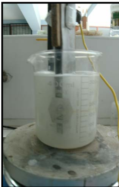
Figura 32: Electrocoagulación por lotes con electrodos de Aluminio. UNI – FIQT Laboratorio de fisicoquímica N° 11
