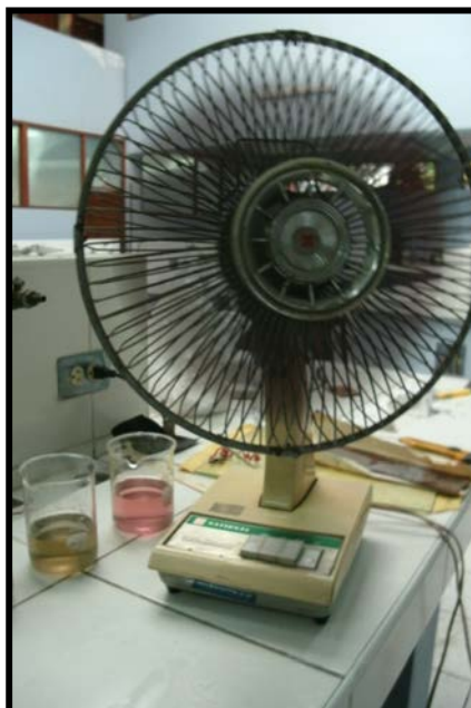
Figura 25: Ventilador usado para enfriar el reactor por lotes. UNI – FIQT Laboratorio de fisicoquímica N° 11
