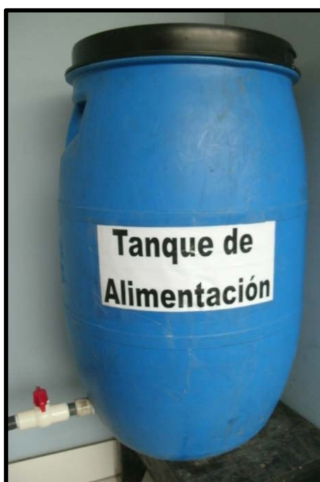
Figura 43: Tanque de alimentación con efluente previamente tratado que ingresa al reactor flujo continuo. UNI – FIQT Laboratorio de fisicoquímica N° 11
