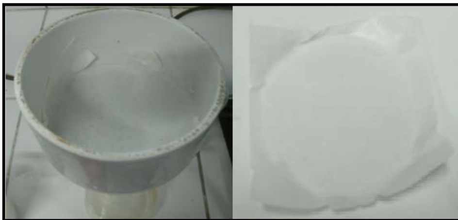
Figura 49: Torta obtenida luego de filtración al vacío. UNI – FIQT Laboratorio de fisicoquímica N° 11
