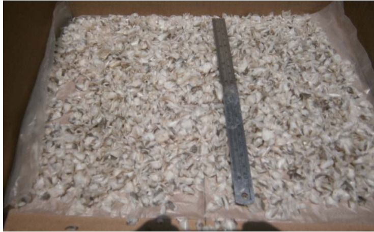
Figura N°4.1 Secado de escamas de pescado lisa al sol a 45°C aproximadamente durante 5 horas.
