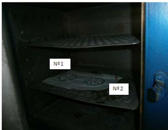
Figura N° 3.1 Ensayo de pérdida de humedad para 2 muestras de 2 gramos, a temperatura de 70°C en la estufa.
