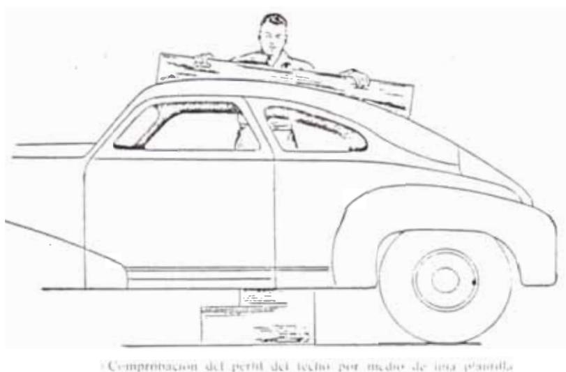
FIGURA 15 PLANTILLAS PARA CONTROL DE LA CHAPA
