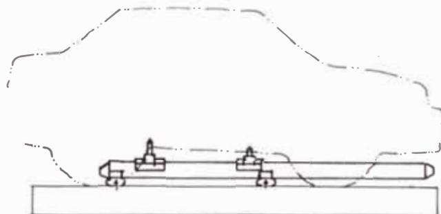
2º Colocación de calibres de referencia y accionamiento de los muelles neumáticos
