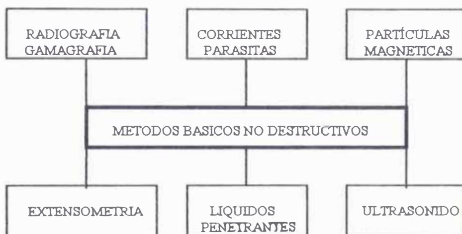
Figura 2.14 Esquema de métodos básicos no destructivos
