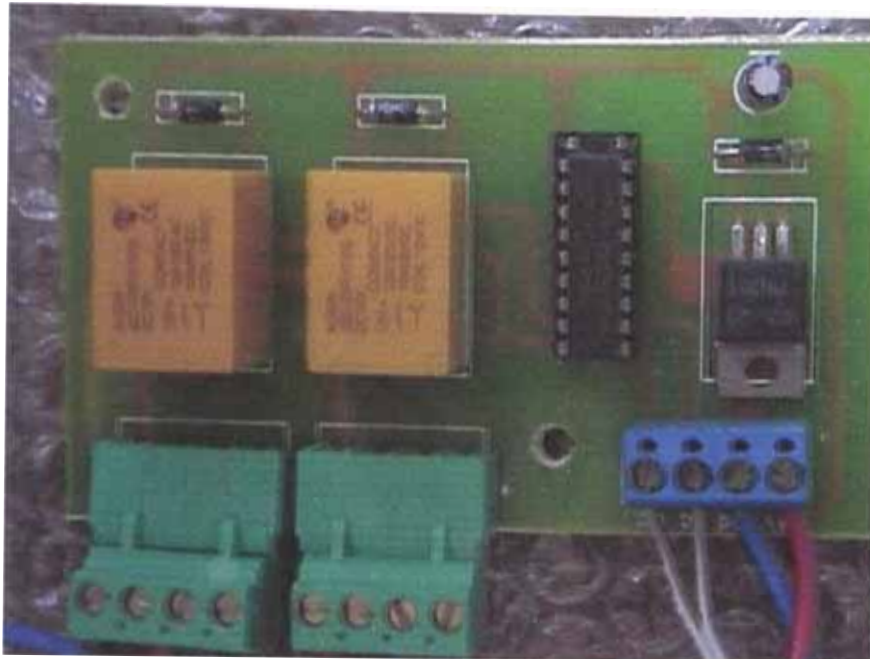
Figura 43: Tarjeta de Relés
