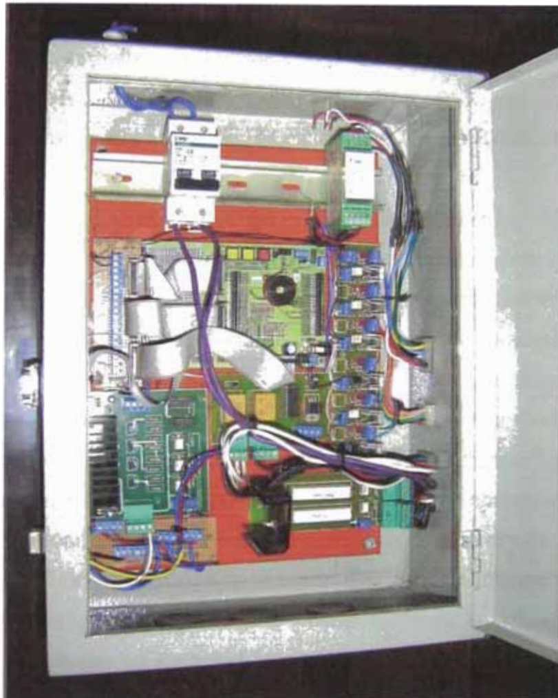
Figura 47: Instalación Final Tarjetas Electrónicas y Microcontrolador
