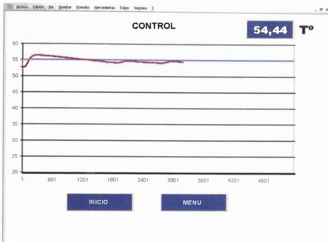
Figura 70: Control Temperatura Setpoint Fijo
