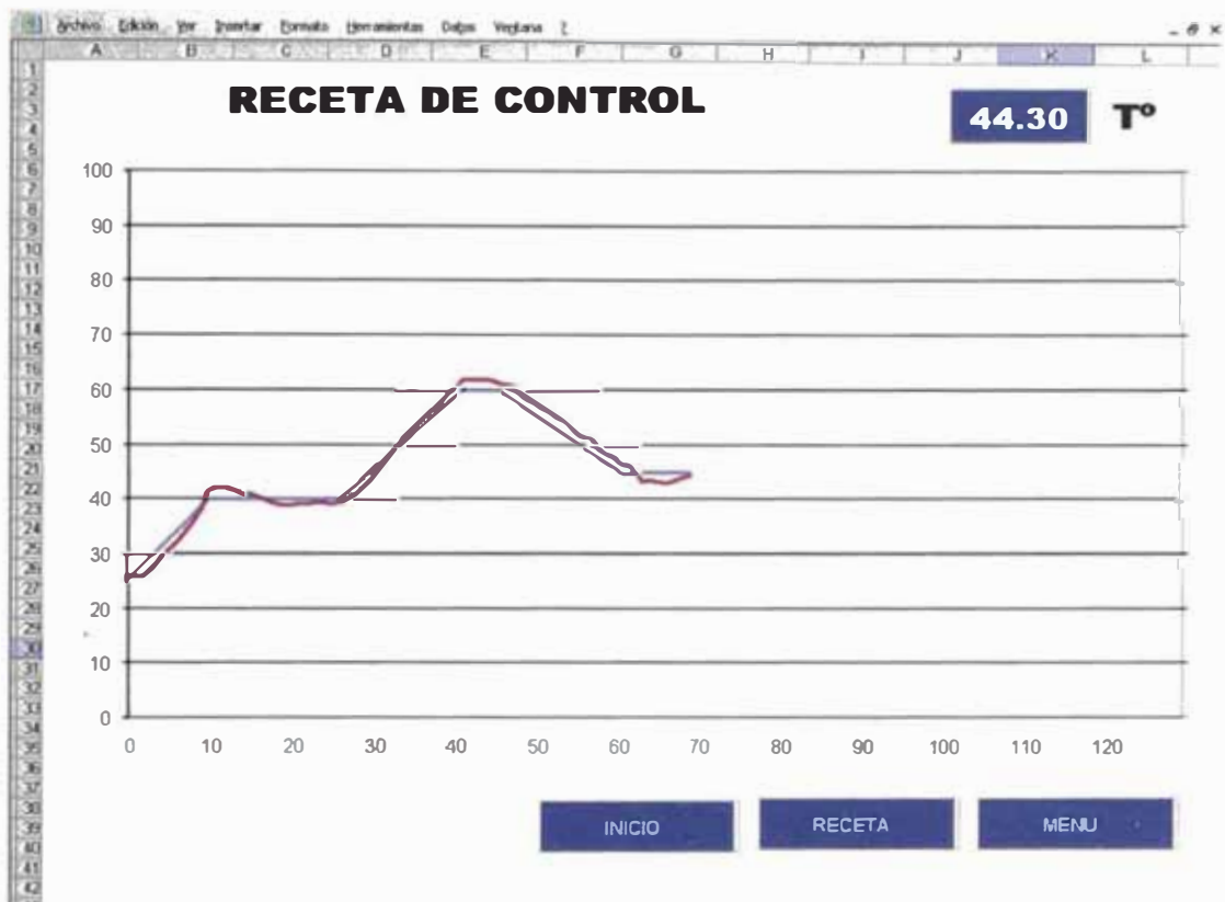
Figura 65: Control de Temperatura - "Receta"
