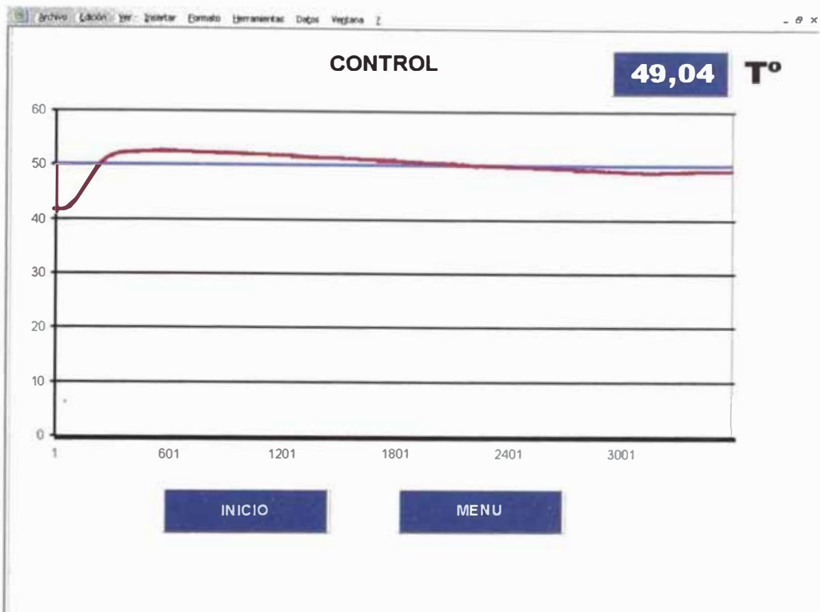
Figura 69: Control Temperatura Setpoint Fijo
