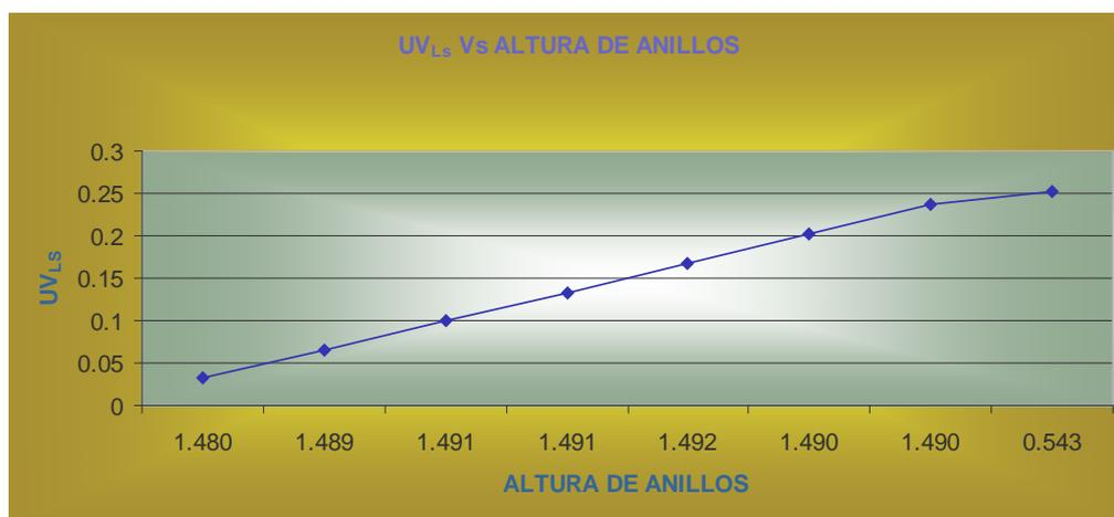
Se puede visualizar como aumenta el valor de la incertidumbre conforme las secciones de los anillos del tanque van tomando mayor altura.
