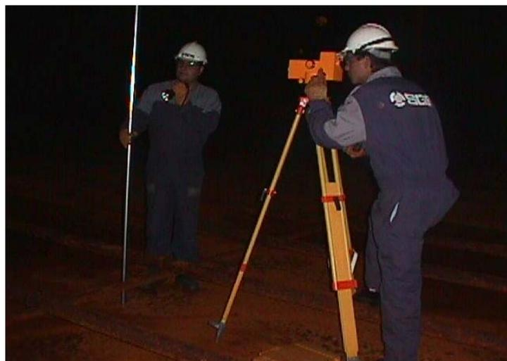
Debido a la naturaleza muy irregular de algunos fondos, las lecturas de inspección deberían ser tomadas en varios puntos para determinar mejor la forma. Cuando se ejecuta una inspección completa del fondo, se deben avistar elevaciones a lo largo
