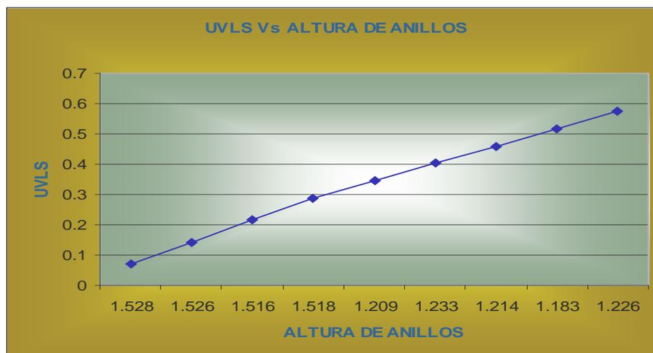
De igual forma, podemos visualizar como aumenta el valor de la incertidumbre conforme las secciones de los anillos del tanque van tomando mayor altura.
