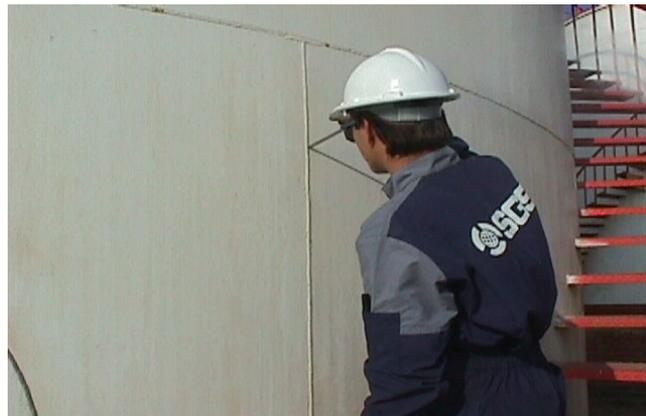
**Figura 6 – 21 Toma de Ancho de las Soldaduras**
