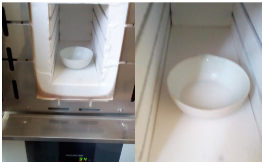
Figura 3.15: La sustancia concentrada es puesta en la mufla (horno) por 5 horas a 100°C. Fuente: Elaboración propia.
