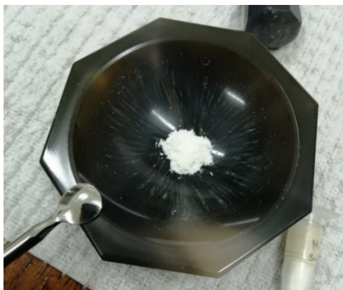
Figura 3.10: Se puede apreciar que la muestra ha sido pulverizada en un mortero de ágata. Fuente: Elaboración propia.
