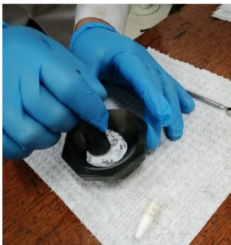
Figura 3.6: Se muestra el proceso de molienda de la muestra obtenida, haciendo uso de un mortero de ágata. Fuente: Elaboración propia.
