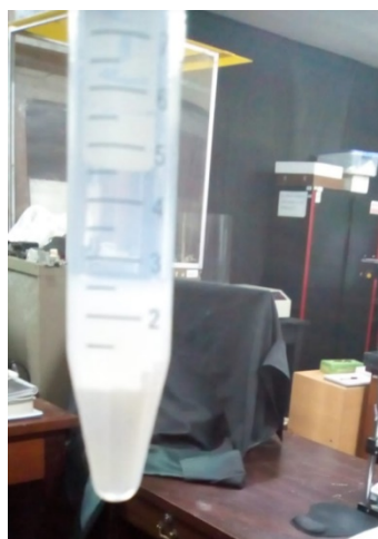
Figura 3.8: Se aprecia el lavado con etanol de la muestra, con el fin de eliminar las posibles impurezas.
