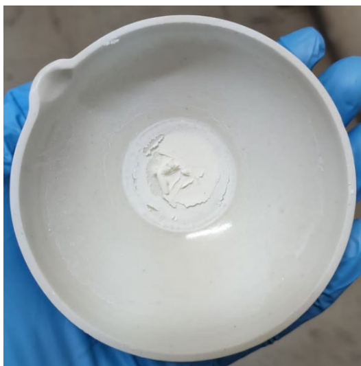
Figura 3.9: Se observa la muestra seca tras ser extraída del horno. Fuente: Elaboración propia.
