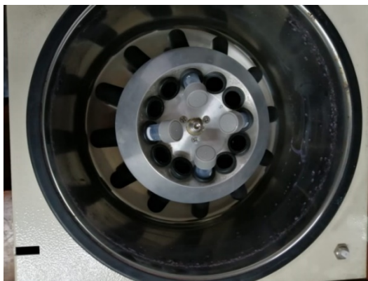
Figura 3.3: Vemos cuatro tubos que contienen la solución antes del proceso de centrifugación. Fuente: Elaboración propia.
