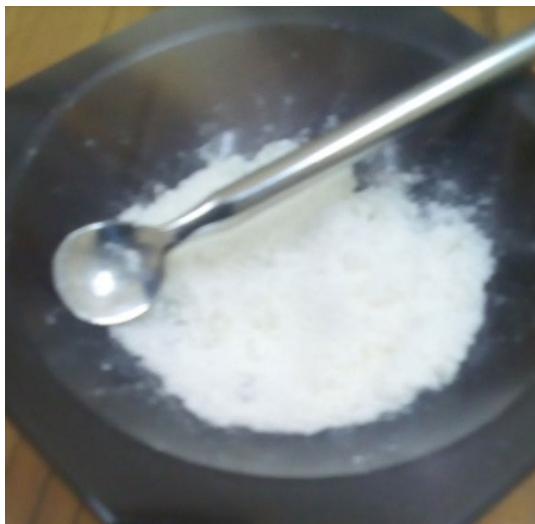
Figura 3.20: El material es molido en un mortero de ágata antes de ser almacenado. Fuente: Elaboración propia.
