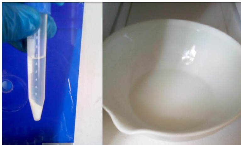
Figura 3.18: El resultado del lavado con etanol es depositado en una cápsula cerámica para su secado.
