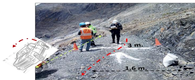
Foto 3: Constatación policial de ancho de vía 3 mts. Existencia de muros de seguridad anteriores y posteriores, en la zona del despiste.
