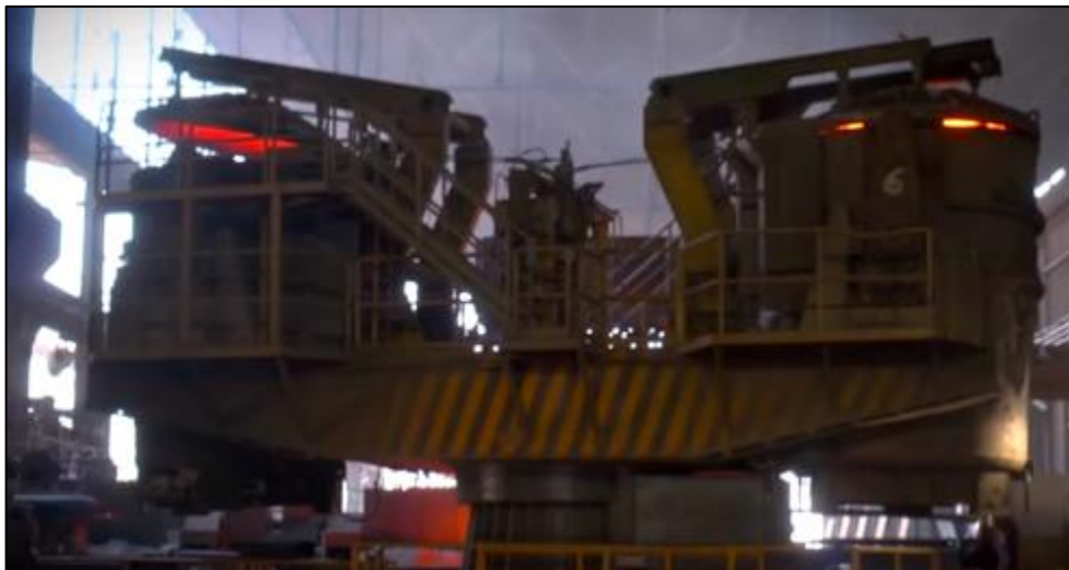
Figura N°27: Horno de cuchara para realizar el afino.
