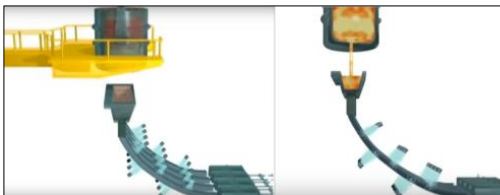
Figura N°28: Pase del acero líquido a la colada continua.
