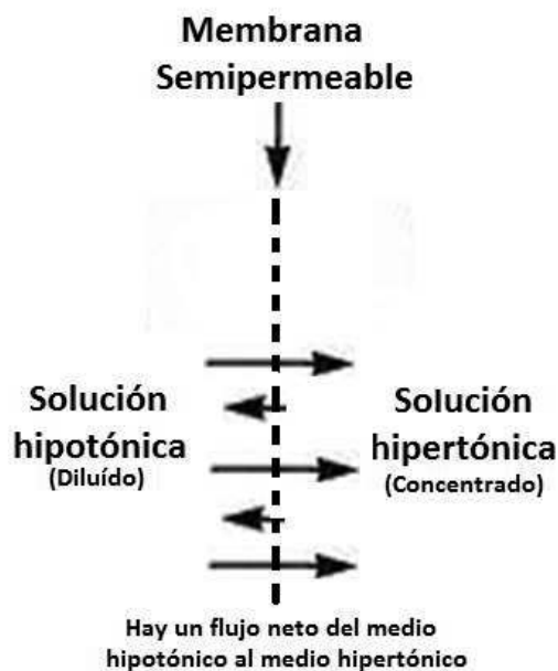
Fig. 2.- Representación del flujo neto de solvente en la ósmosis
