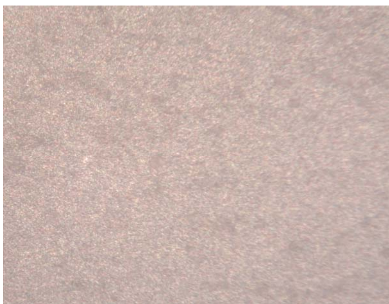
Foto N° 11.8. Muestra M10S2, pH 4 , 1 A/dm 2 ánodo de Zn, Temp.25°C, tiempo 5min,10x/20*8/0.2
