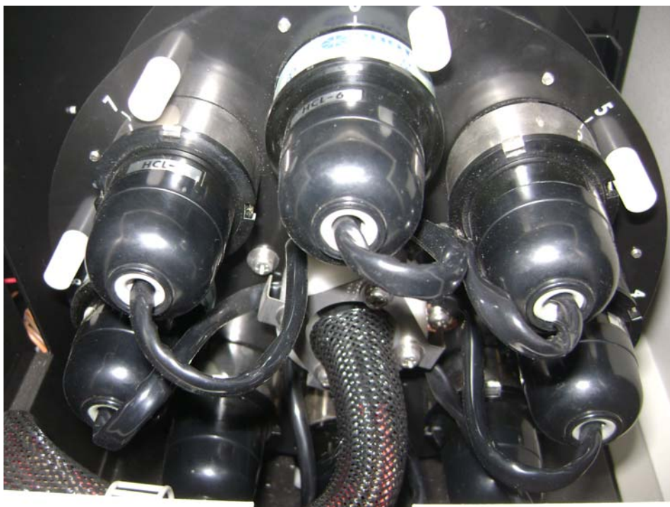
Foto N° 8.8 Lámparas de cátodo hueco instaladas en el equipo de Espectrofotometro de Absorción Atómica AA 6701 F UNI-FIQT/ Laboratorio N° 21.
