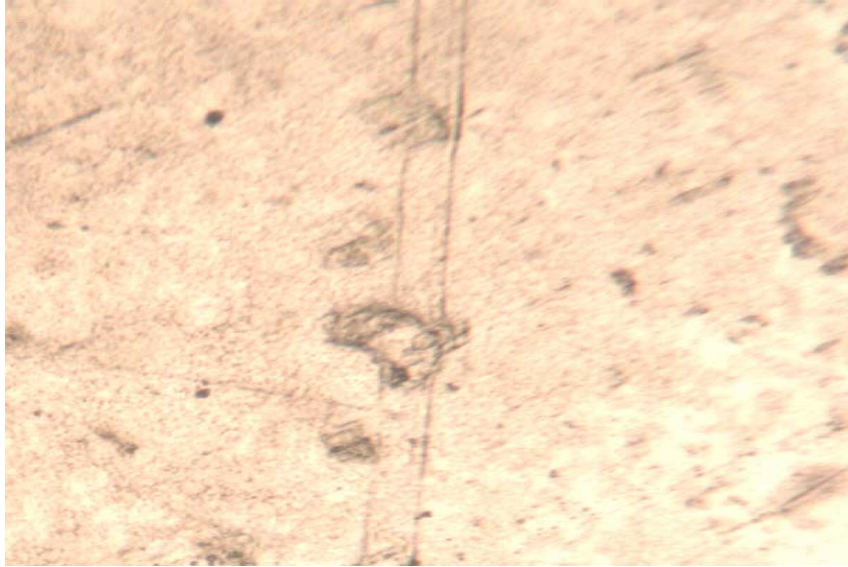
Foto N° 11.12 Muestra M15S2 , pH 3, 1 A/dm 2 ánodo de Pb, Temp.50°C , tiempo 5min,10x/20*16/0.35
