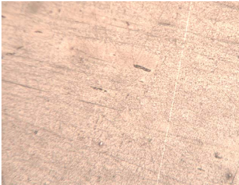
Foto N° 11.13. Muestra M16S2, pH 3, 1 A/dm 2 ánodo de Pb, Temp.55°C , tiempo 5min,10x/20*8/0.2
