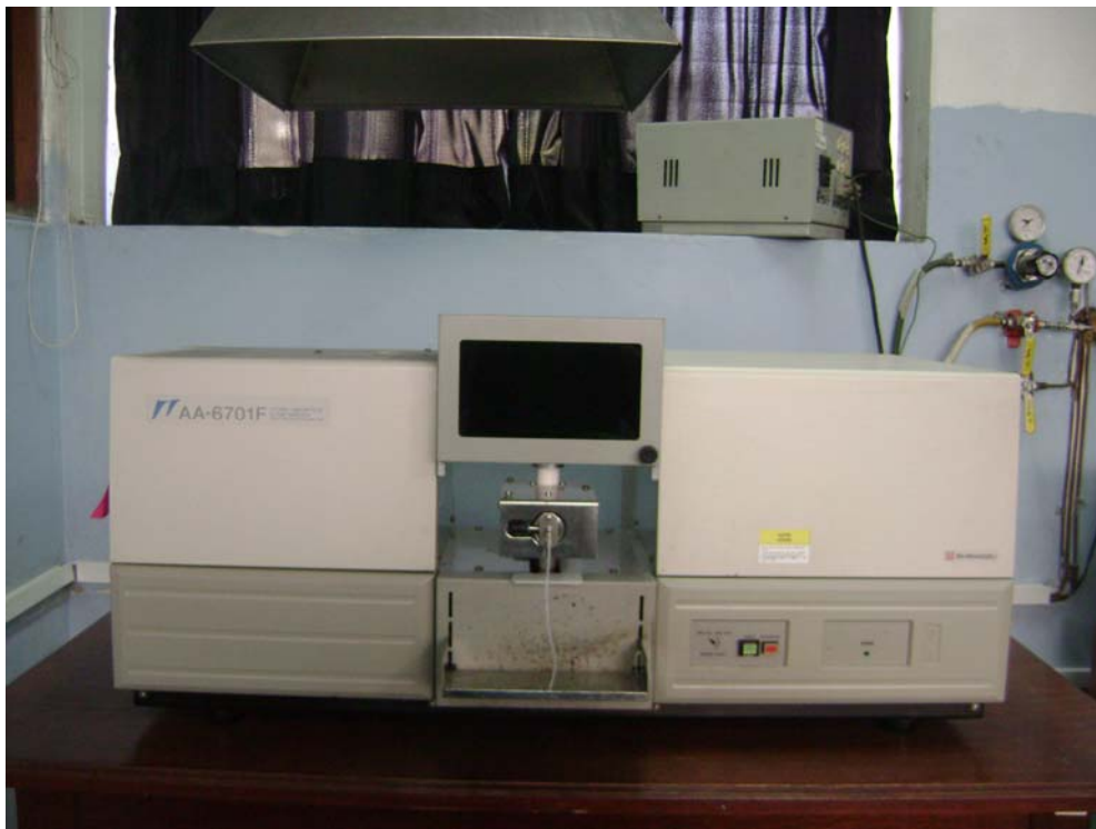
Foto N° 8.9 (a) vista del quemador ranura por donde sale la llama, ( b ) Equipo : Espectrofotómetro de Absorción Atómica AA 6710 F UNI-FIQT/Laboratorio 21.
