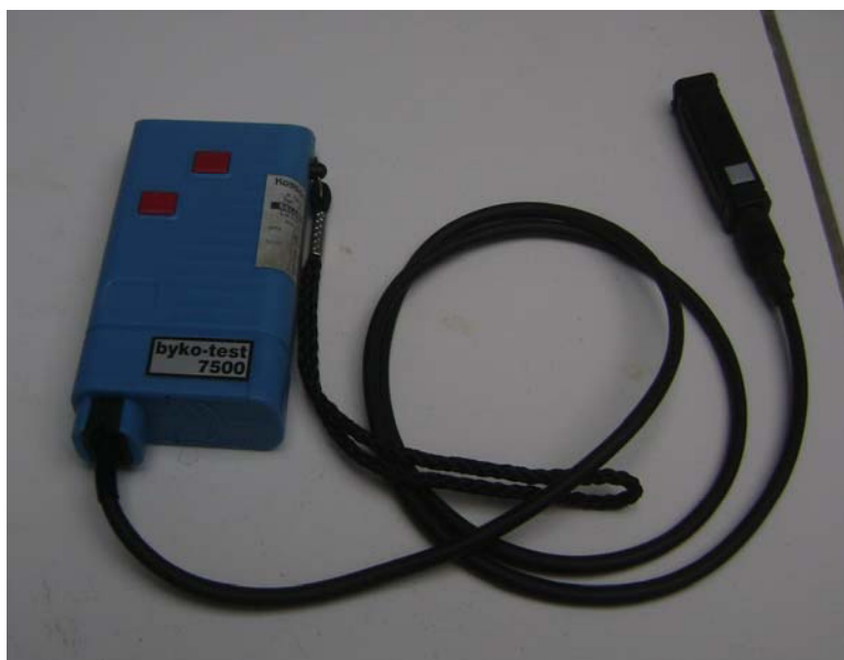
Foto N° 8.6 Micrometro byko test 7500 para medir el espesor de películas metálicas no magnéticas sobre base ferromagnética y no ferromagnética. UNI-FIQT/ Laboratorio corrosión electroquímica 211 A.
