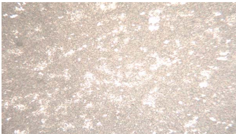
Foto N° 11.5 Muestra M1S2 , pH 2.5 , 1 A/dm 2 ánodo de Zn, Temp.25°C, tiempo 5min,10x/20*8/0.2
