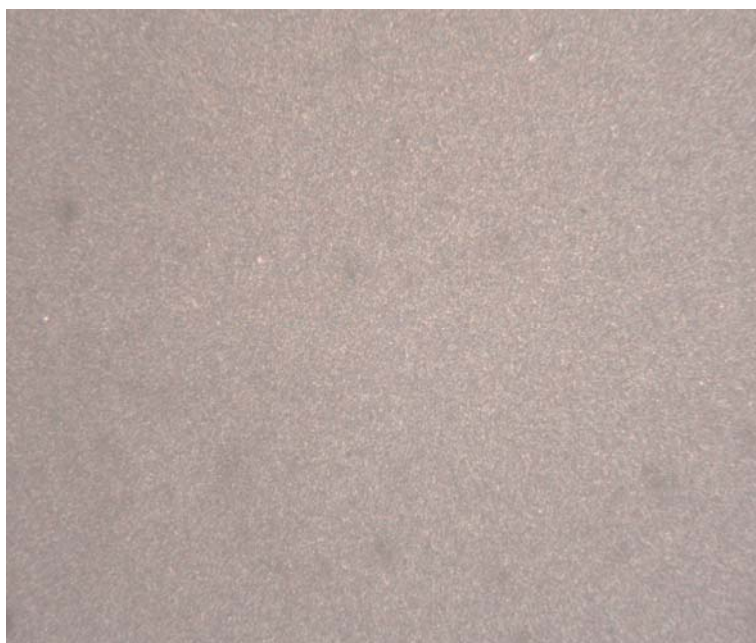
Foto N° 11.7. Muestra M7S2, pH 3.5 , 1 A/dm 2 ánodo de Zn, Temp.25°C, tiempo 5min,10x/20*8/0.2
