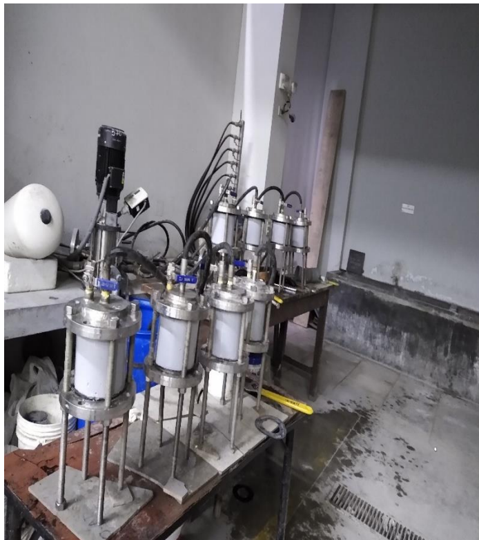
FIGURA D.18: Instalación de Probetas Para ensayo de permeabilidad Capítulo VI – Pagina N°102
