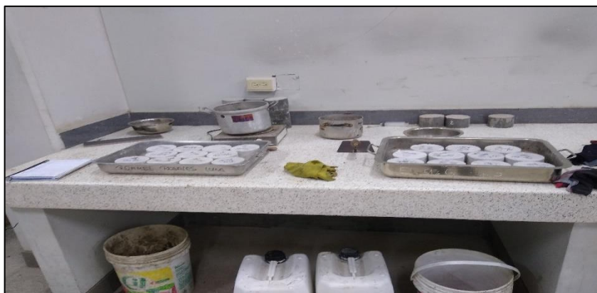
FIGURA N° 2.2: Absorción capilar de muestras de concreto. Fuente: Elaboración propia
