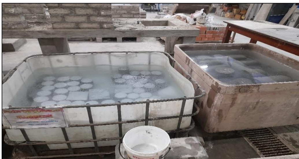
Figura N°2.5 Poza de curado de muestras para diferentes ensayos Fuente: Elaboración Propia.
