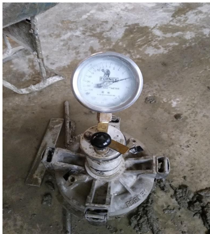
FIGURA D.10: Ensayo de Contenido de Aire. Capitulo V – Pagina N°87
