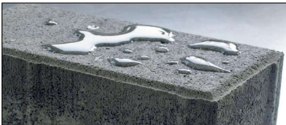
FIGURA N° 2.1: Reducción de la Permeabilidad del concreto. Fuente: Sika mexicana, 2013
