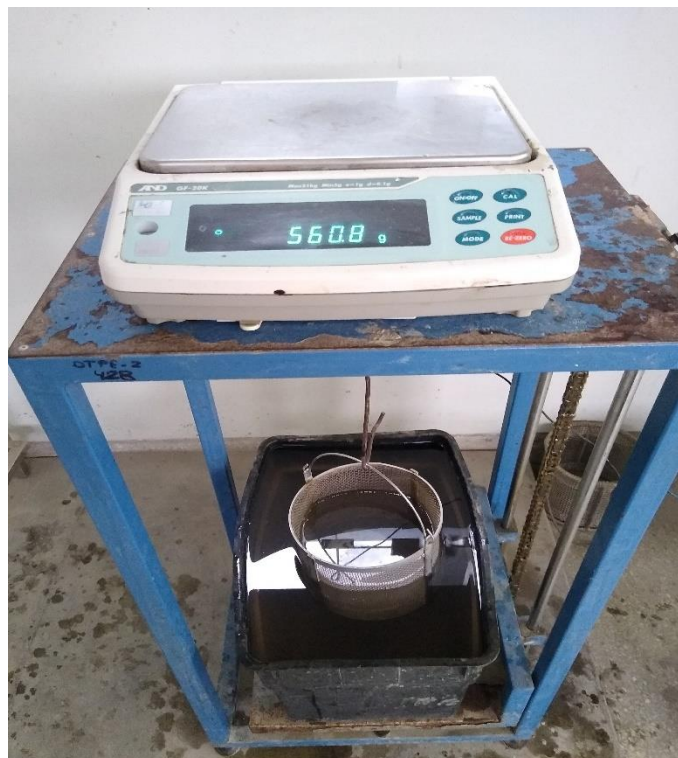
FIGURA D.16: Calculo del Peso Sumergido Aparente. Capítulo VI – Pagina N°99
