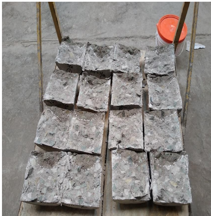
FIGURA D.20: Penetración del agua en las probetas. Capítulo VI – Pagina N°103
