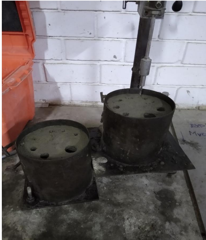
FIGURA D.11: Ensayo de Tiempo de Fragua. Capítulo V – Pagina N°91
