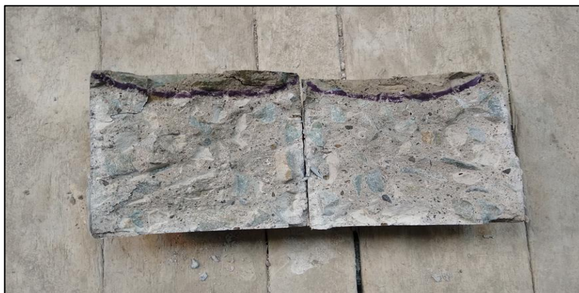
FIGURA N°2.3 Muestra cilíndrica de concreto con penetración de agua por presión hidrostática. Fuente: Elaboración Propia
