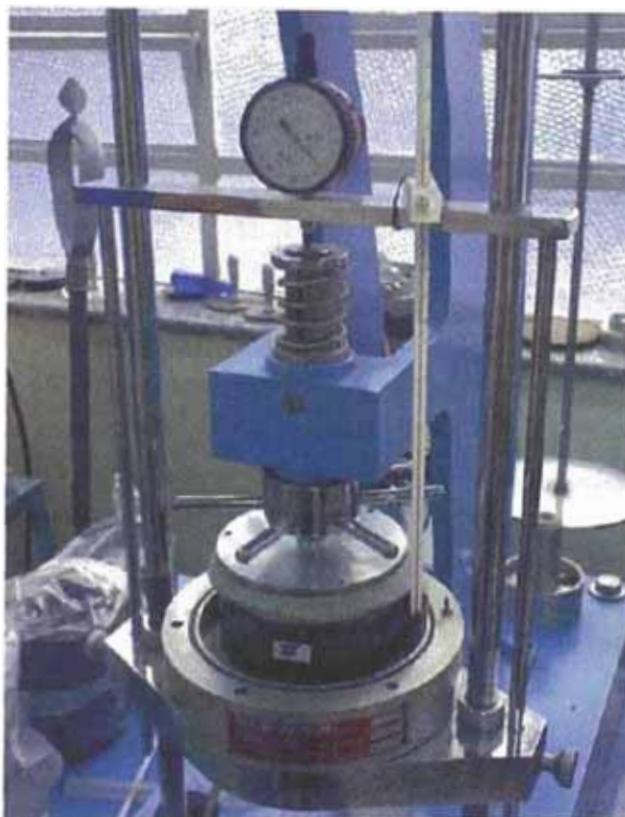
**Foto No 5.3: Ensayos de compresión edométrica cíclico.
