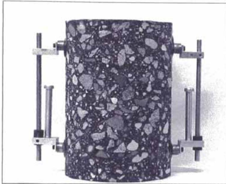
(a) Muestra para ensayo triaxial cíclico
