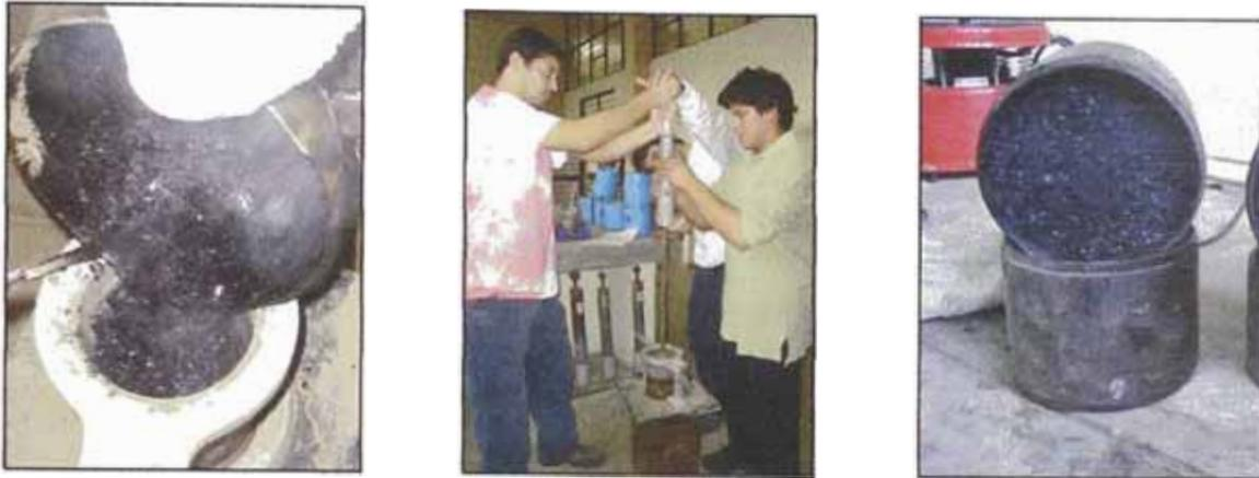
**Foto 6.1: Preparación de especímenes Superpave y Stone Mastic Asphalt.
