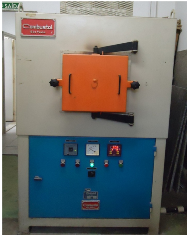
Figura 16 - Horno eléctrico de mufla (Combustol)
