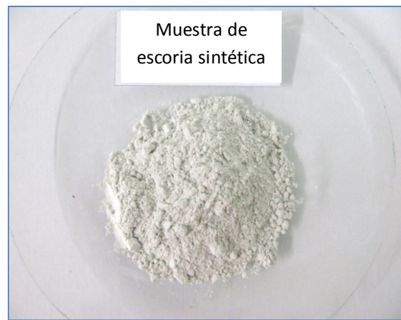
Figura 20 - Muestras de las mezclas de los insumos puros “escoria sintética”
