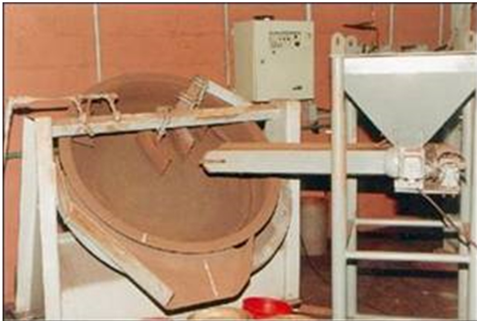
Figura17 - Disco piloto para producción de pellets crudas
