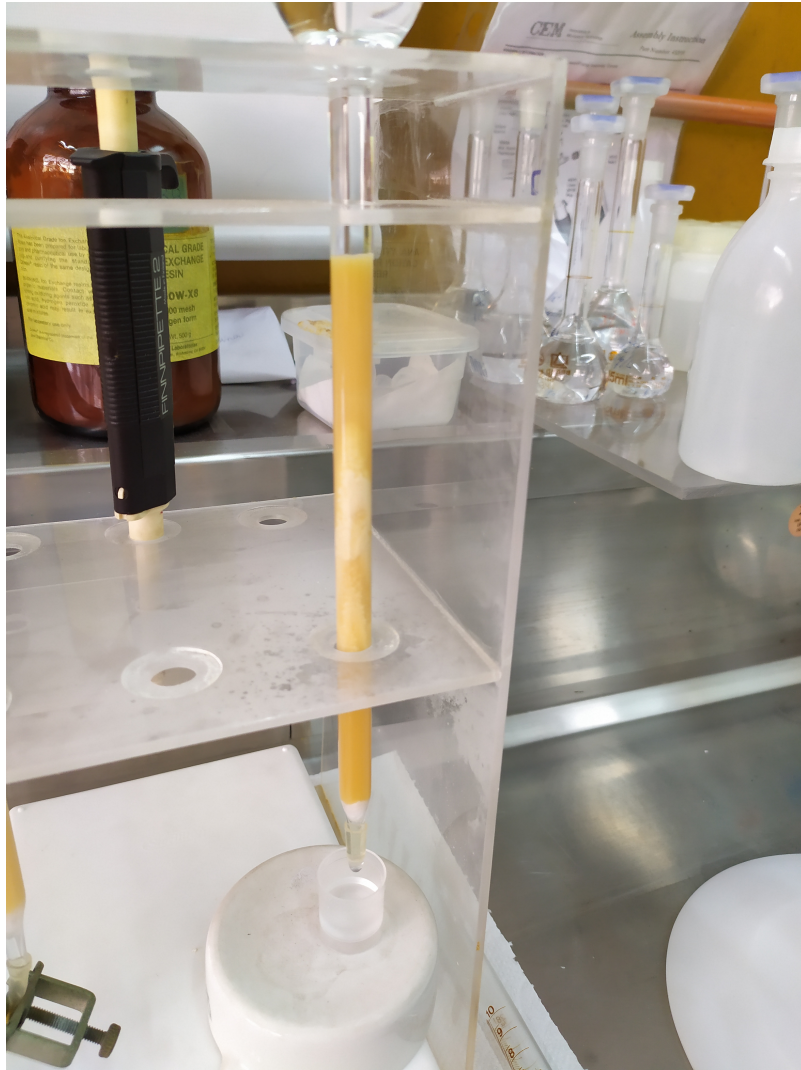
Figura 52: Columna de intercambio iónico con sal de EDTA precipitada debido al cambio de pH
