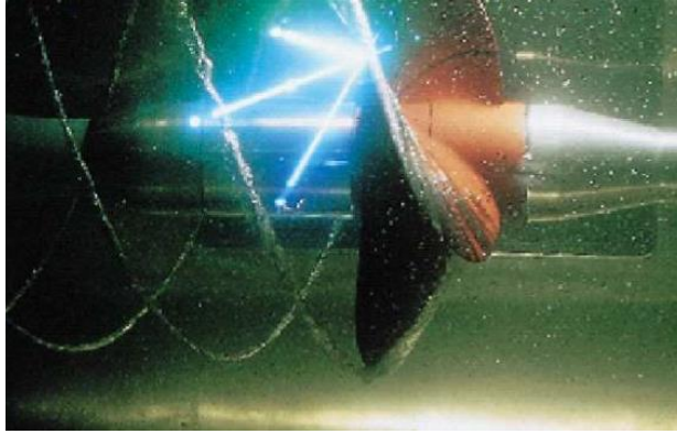
Figura ii.2 Caracterización de una bomba de agua (izquierda). Caracterización de las turbulencias de las hélices de un barco en un canal hidrodinámico (derecha) [3].
