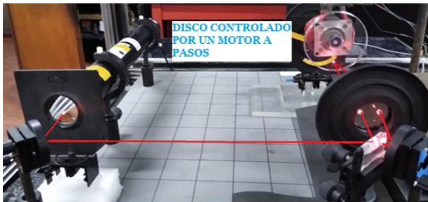
Figura 5.7 Esquema del velocímetro láser Doppler para detectar la velocidad angular de un disco rotado por un motor a pasos.
