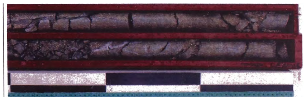
FIGURA 3.20 ESTRUCTURA EPITERMAL DE PIRITA MASIVA GRANULAR CON SILICIFICACIÓN FUERTE SOBREIMPUSTA. TESTIGO DE DIÁMETRO NQ.
