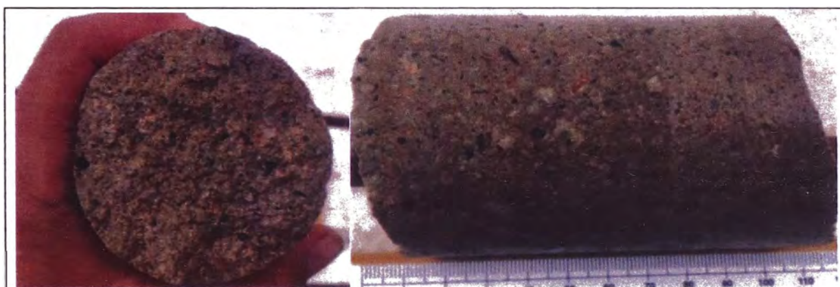
FIGURA 3.16 INTRUSIVO DACITICO BIOTITICO; PRESENCIA DE FENOCRISTALES DE PLAGIOCLASAS ARGILIZADAS Y CRISTALES DE BIOTITA. TESTIGO DE DIÁMETRO HQ.
