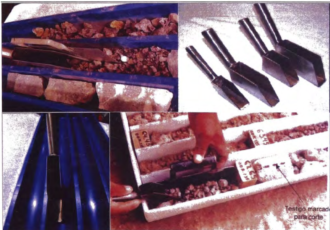
FIGURA 2.1. FORMA CORRECTA DE MUESTREO DE MATERIAL SUELTO CON LAS HERRAMIENTAS ADECUADAS.
