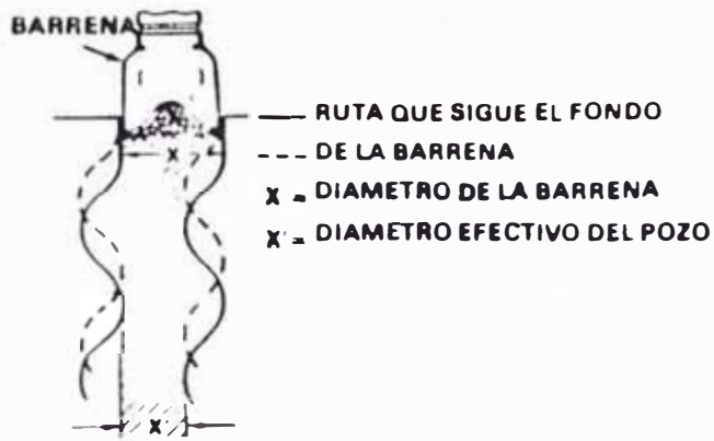
FIG. 1 El pozo en forma de espiral, ocasionado por barrena inestabilizada que perfora en formaciones carentes de buzamiento tiene un diámetro efectivo menor que el diámetro exterior de la barrena
