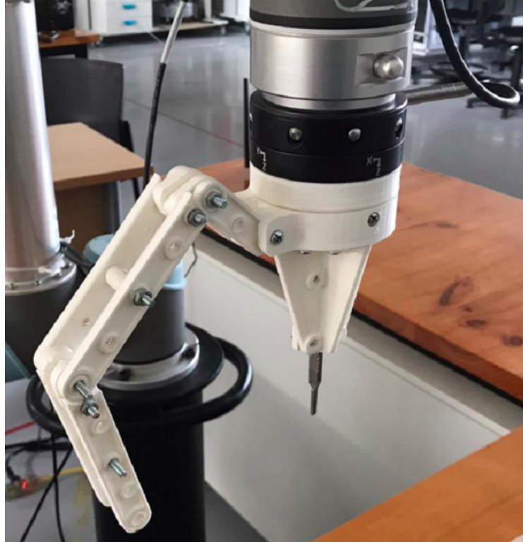
Figura 4.10: Efecto final acoplado al sensor FT300, sosteniendo un bisturí. Esta fotografía fue tomada en el Laboratorio de Mecatrónica de la Universidad de Ingeniería y Tecnología UTEC.
