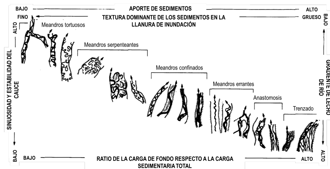
Figura N° 3 Efecto de carga de sedimentos en la planimetría de ríos aluviales
