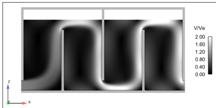
Figura N° 24 Distribución de la magnitud de velocidad en la cámara de contacto obtenida con el modelo de turbulencia k-ε.
