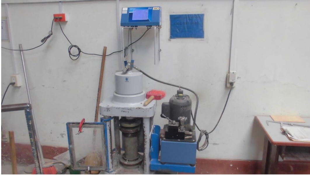
Ensayo de resistencia a la compresión
