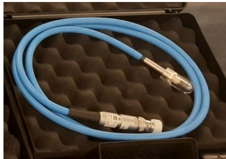
Figura N°3.3 Cámara de ionización semiflex para uso de haces de megavoltaje. Fuente [Elaboración Propia]
