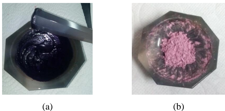
Figura 2.1. (a) Mezcla viscosa al iniciar el proceso de molienda. (b) Muestra molida sólida de tono palo rosa 30 min después de iniciado el proceso.
