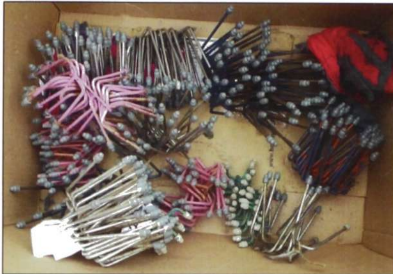
Figura N° 2.13.- Sillas de soporte Fuente: Samayca Ingenieros SAC
