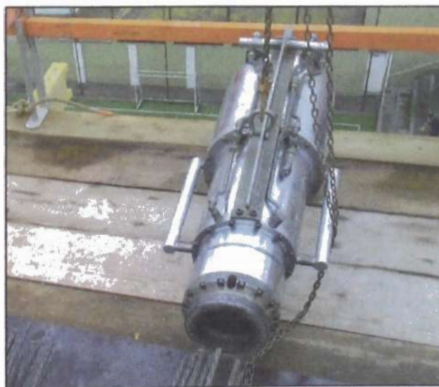
Figura N° 2.22.- Gato Hoz 3000 (8 a 12 cables)
