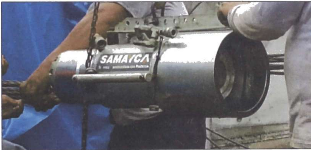
Figura N° 2.24.- Gato Hoz 1700 (Hasta 7 cables) Fuente: Samayca Ingenieros SAC
