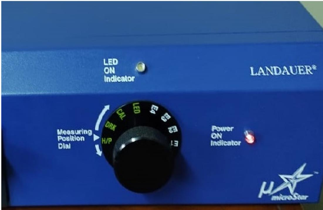
Figura 3.5: Perilla indicadora de las diferentes posiciones para lectura y calibración
