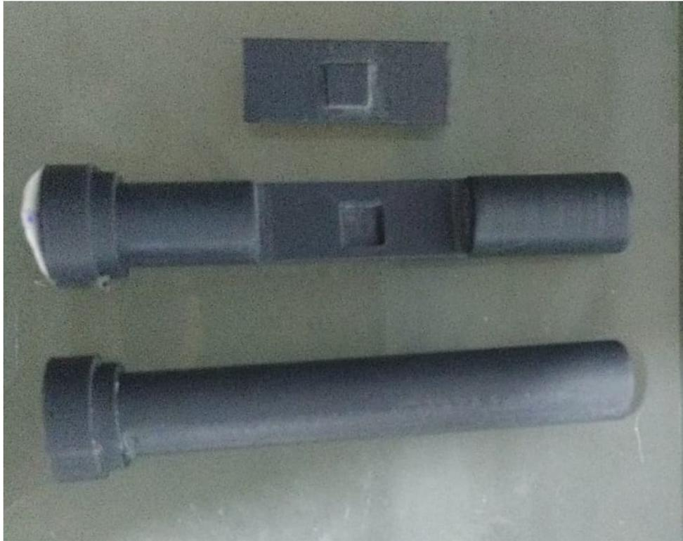
Figura 3.16: Aplicadores diseñados con PLA para CI (abajo), para OSLD (arriba)
