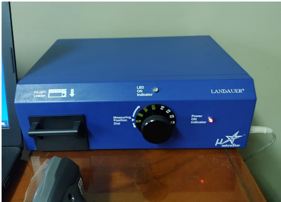
Figura 3.3: Lector *MicroStar* - láser QR
