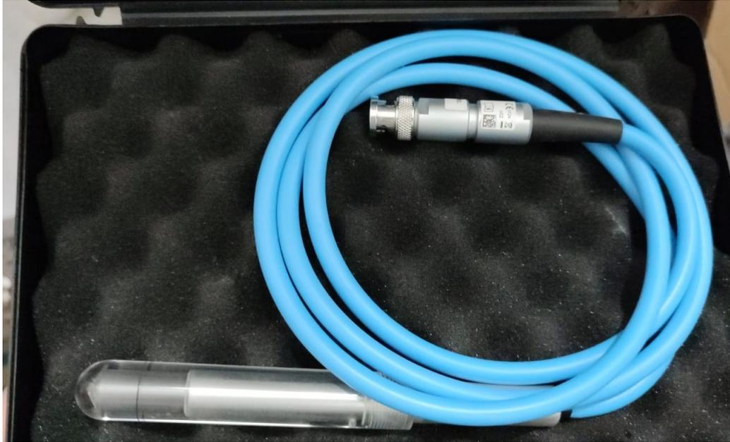
Figura 3.8: Cámara de Ionización Tipo Farmer
