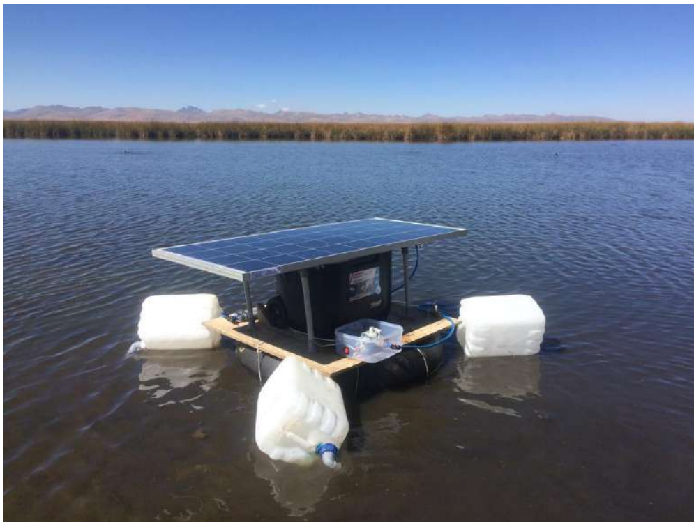
Figura 44. Vista anterior. Prototipo boya descontaminadora implementada y en operación. Lago Chinchaycocha. Captura: Mayo 2019
