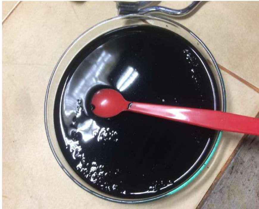
Figura 27. Arena recubierta con Magnetita ( \text{Fe}_3\text{O}_4 ) en una dispersión de Óxido de Grafeno (GO) para la producción a nivel de laboratorio "AreMaGo"
