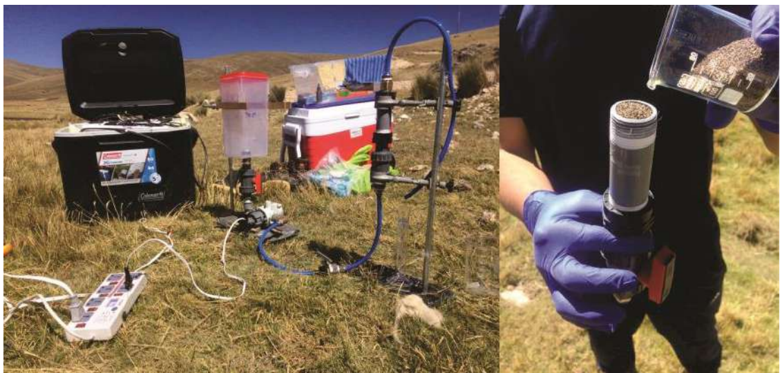
Figura 32. (A la izquierda) Sistema montado para los ensayos de columna. (A la derecha) llenado del filtro con el material adsorbente Aremago
