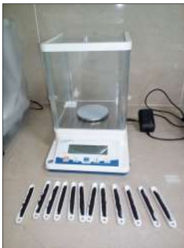
Figura N°3.10. Pesaje de las muestras de residuos anódicos en balanza analítica.
