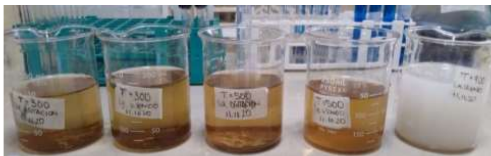
Figura N°3.24. Secuencia de la precipitación del plomo con \text{NaOH} de las soluciones lixiviadas en baño de ultrasonido y plancha de agitación magnética.
