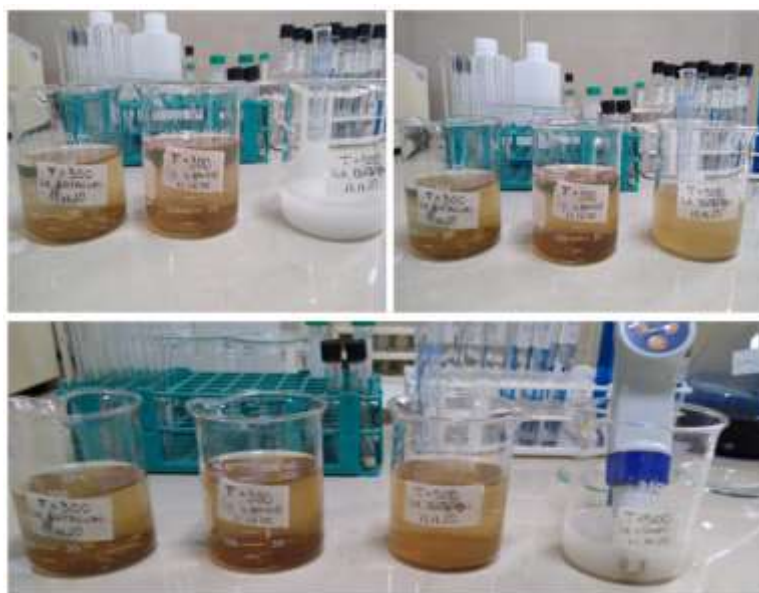
Figura N°3.22. Procedimiento para precipitar el plomo como \text{Pb}(\text{OH})_2 de las soluciones lixiviadas empleando solución de NaOH.
