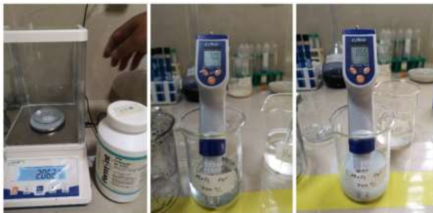
Figura N°3.23. Procedimiento para precipitar el plomo como \text{Pb}(\text{OH})_2 de las soluciones lixiviadas empleando solución de \text{NaOH} a muestras de 300 y 500°C.
