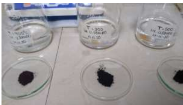
Figura N°3.18. Muestras calcinadas a 300°C,500°C y 900°C para lixiviarlas en baño de ultrasonido.
