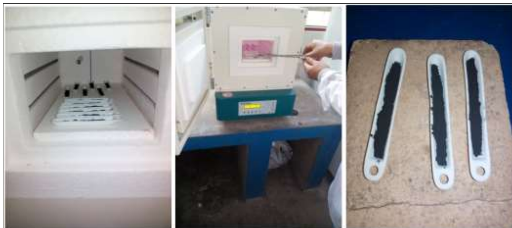
Figura N°3.11. Pruebas de Descomposición Térmica en Horno Mufla a 700°C, 800°C, 900°C y 1000°C.
