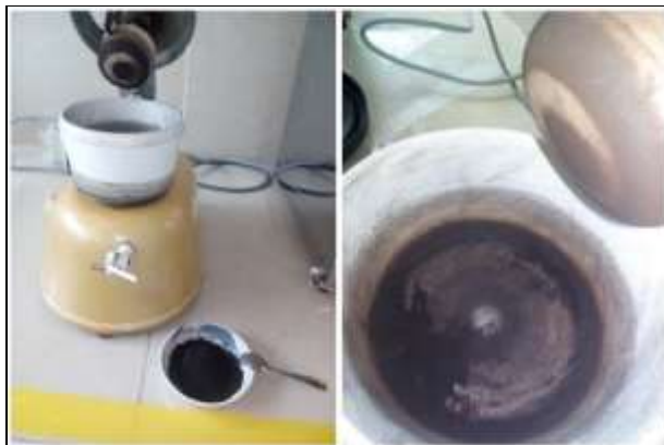
Figura N°3.8. Pulverizador cerámico y muestra de residuo anódico pulverizada (Fuente: Elaboración propia )
