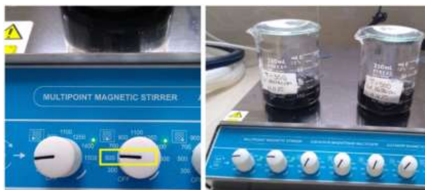
Figura N°3.17. Lixiviación de los residuos de MnO_2 calcinadas a 300 y 500°C mediante la agitación magnética a 500 RPM.
