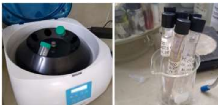
Figura N°3.21. Centrifugado de las 5 muestras lixiviadas y su envío a análisis por Absorción Atómica
