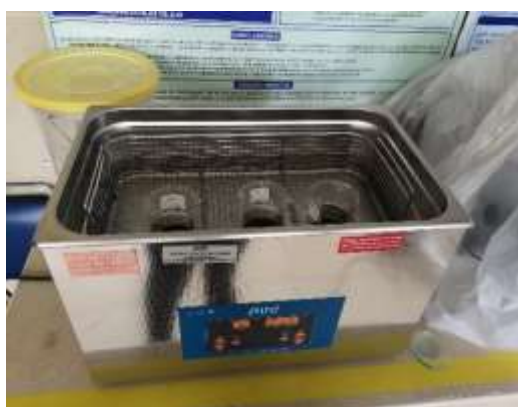
Figura N°3.19. Lixiviación de los residuos de MnO_2 calcinadas a 300, 500 y 900°C en Baño de Ultrasonido. Frecuencia constante de 40KHz.
