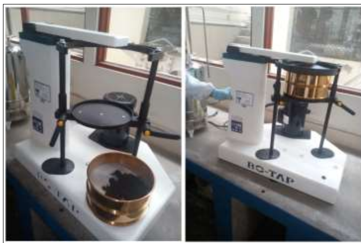
Figura N°3.9. Tamizador Ro-Tap y Malla 200 Tyler (Fuente: Elaboración propia )
