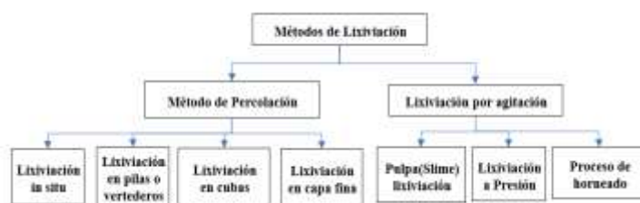
Figura N°2.3. Clasificación de métodos de lixiviación
