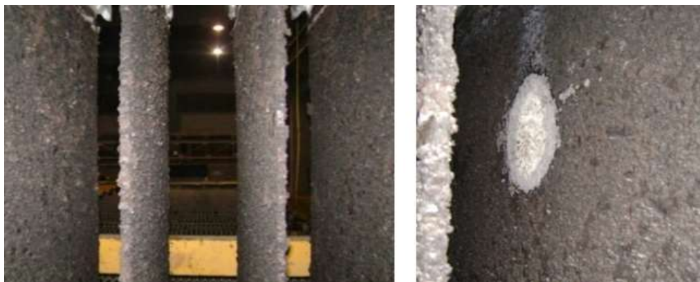
Figura N°1.5. Dióxido de manganeso en ánodos y corto generado.
