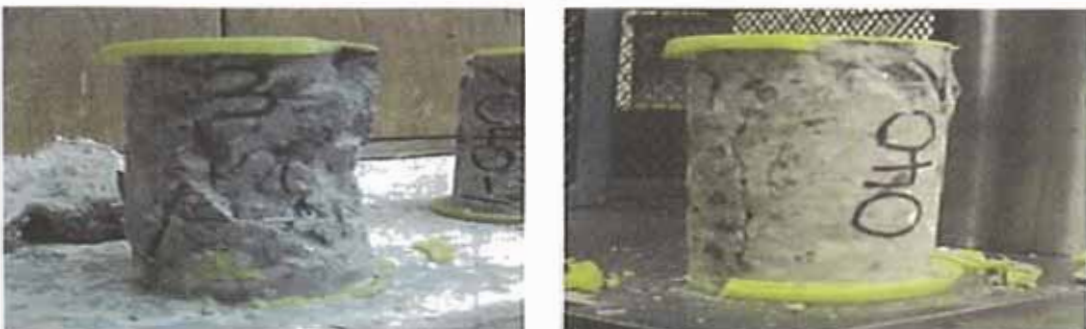
Figura N°2.6.- Muestras ensayadas a compresión, falla de cono y corte.
