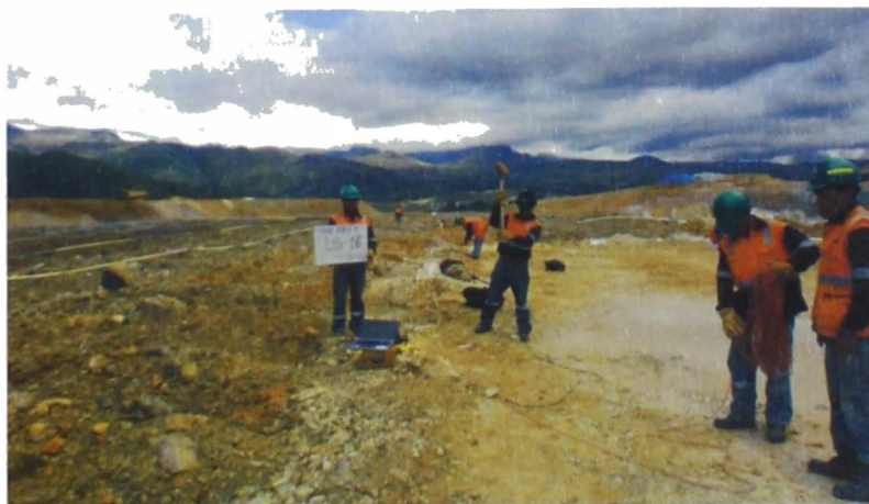
Figura 4.12: Esquema general de la ejecución de un ensayo MASW
