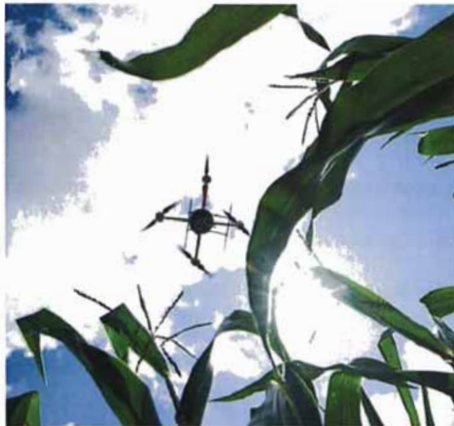
Figura 1.9: Cuadricóptero usado para riego de zonas de cultivo.
