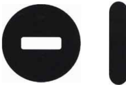
Figura 5.5: Imagen prediseñada que es detectada por defecto por la unidad de procesamiento del Parrot AR.Drone.
