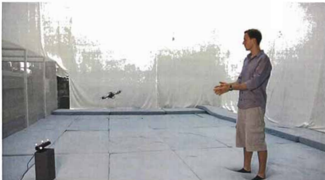
Figura 1.16: Interacción con un cuadricóptero via Kinect. The Flying Machine Arena, ETH Zürich: http://www.youtube.com/watch?v=A52FqfOi0Ek
