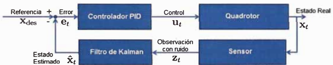
Figura 4.13: Diagrama de bloques para el control de posición del cuadricóptero mediante estimación de estado aplicando filtro de Kalman.
