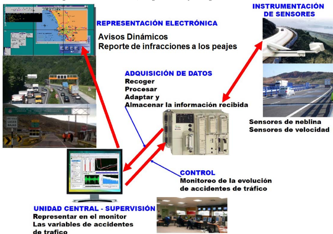
Figura 05: SISTEMA SCADA PROPUESTO "Supervisory Control And Data Acquisition" (Control, Supervisor y Adquisición de Datos)
