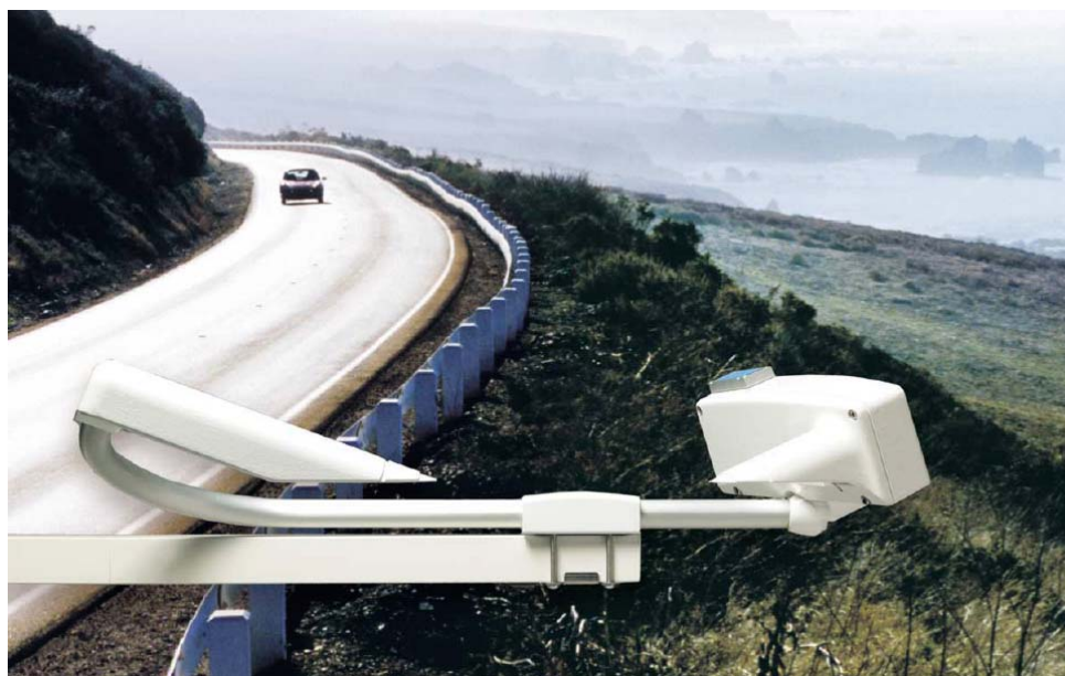
Figura 07: Sensor de visibilidad en carreteras.
