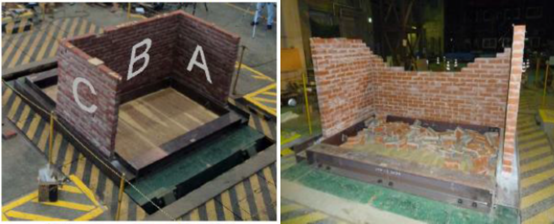
Ensayos realizados a la albañilería sin confinar (Fuente: CISMID)
